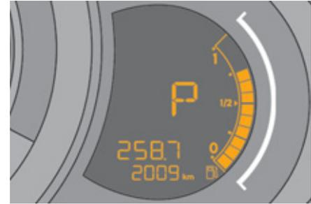
Quando deslocar a alavanca na grelha para seleccionar uma posição, acende-se o respectivo indicador no visor do quadro de bordo.
