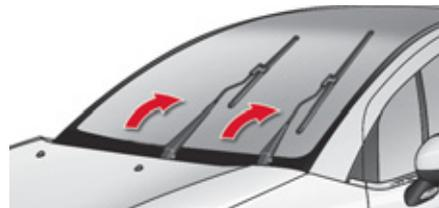
Esta posição permite que as escovas fiquem elevadas para o estacionamento de Inverno, sejam limpas ou substituídas sem danificar o capot. No minuto que se segue ao corte da ignição, qualquer acção no comando do limpa-vidros posiciona as escovas na vertical. Para reposicionar as escovas após intervenção, ligue a ignição e manuseie o comando.
