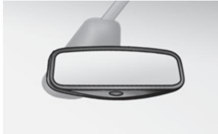
Graças a um sensor, que mede a luminosidade proveniente da traseira do veículo, este sistema garante de forma automática e progressiva a passagem entre as utilizações de dia e de noite.
