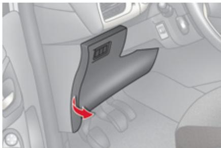
A pinça de extracção e os alojamentos dedicados aos fusíveis de substituição encontram-se instalados na parte de trás da tampa da caixa de fusíveis do painel de bordo.
