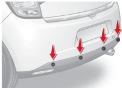
Detecta qualquer obstáculo (pessoa, veículo, árvore, barreira, ...) situado por trás do veículo, excepto os obstáculos situados exactamente sob o pára-choques.
