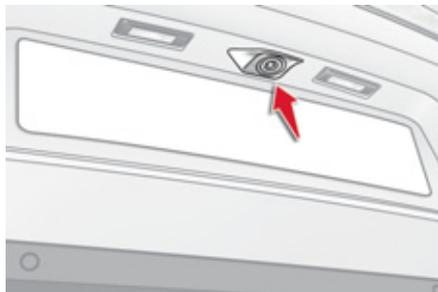
Uma câmara de marcha-atrás é activada automaticamente ao engrenar a marcha-atrás. O retorno visual a cores é efectuado no ecrã de navegação.
