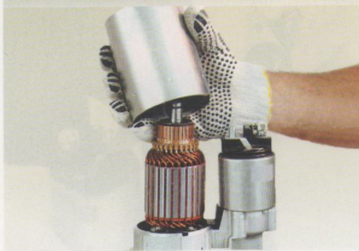
Fig. 5 - Remoção da carcaça com ímãs
