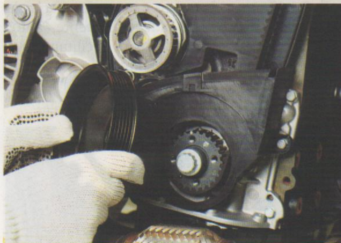
Fig.2 - Remoção da polia da árvore de manivelas
