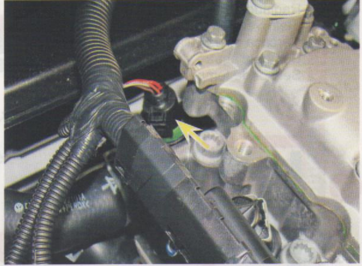
Fig.4 - Localização do sensor de temperatura ECT
