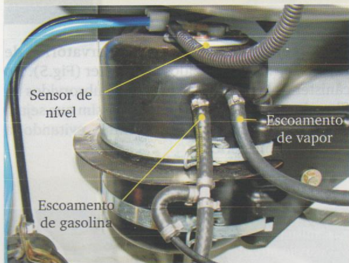
Fig.1 - Res. auxiliar de gasolina para partida a frio
