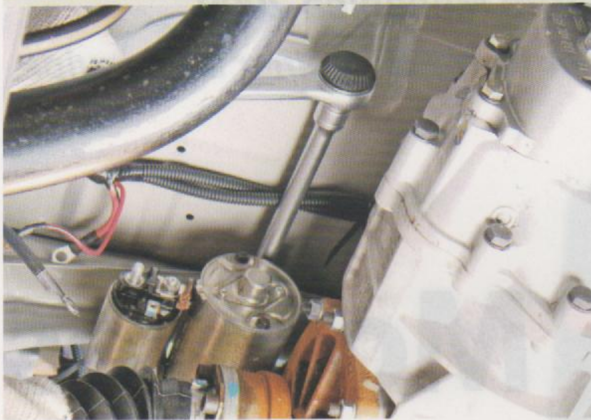
Fig. 2b - Fixação do motor de partida
