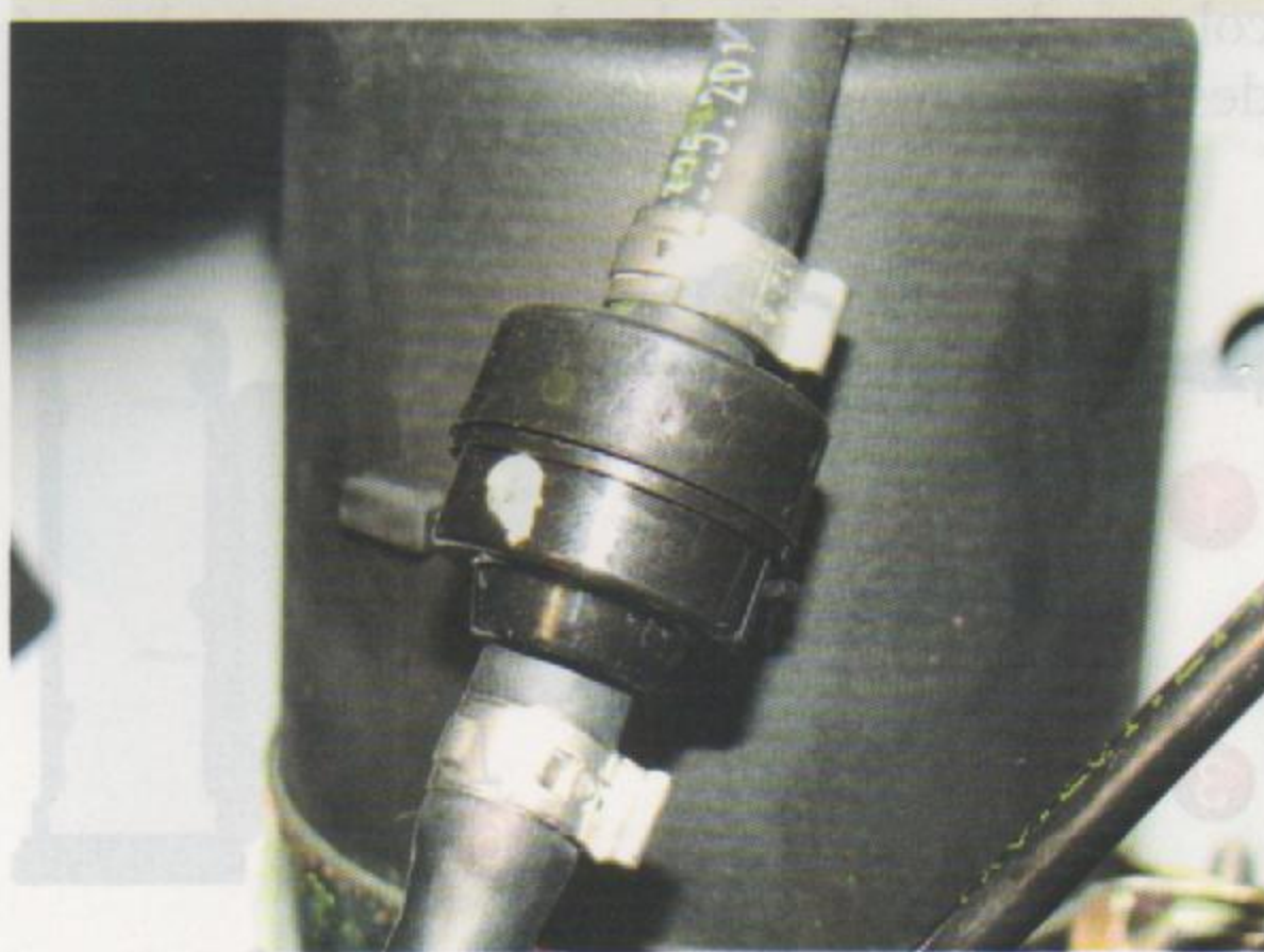
Fig.7 - Válvula de ventilação
