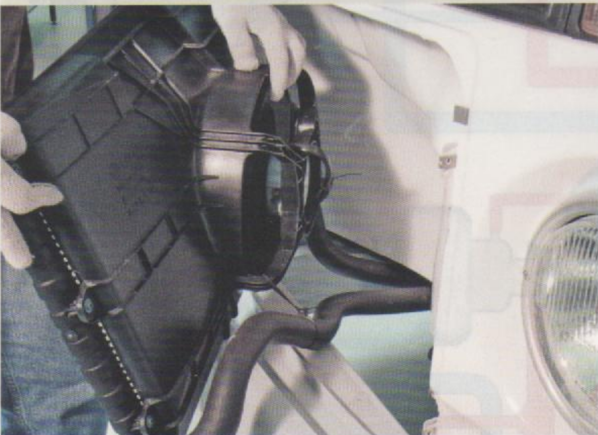
Fig.5 - Localização do eletroventilador
