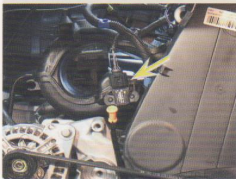
Localização do conjunto medidor de densidade - CMD
