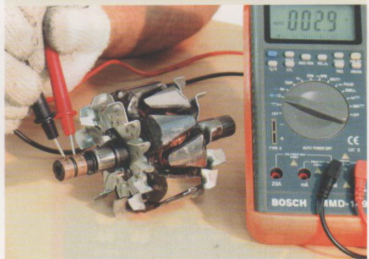
Fig.2 - Valor da resistência do enrolamento
