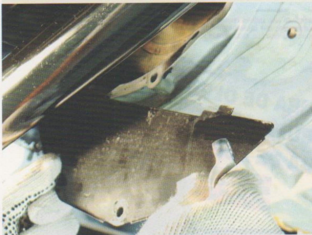
Fig.3 - Remoção da chapa de proteção da embreagem
