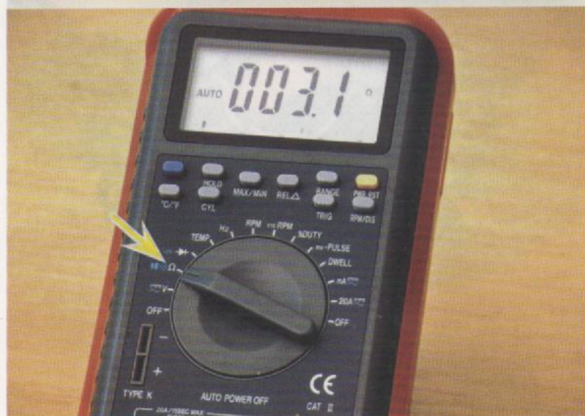
Fig.1 - Instrumento na função de resistência
