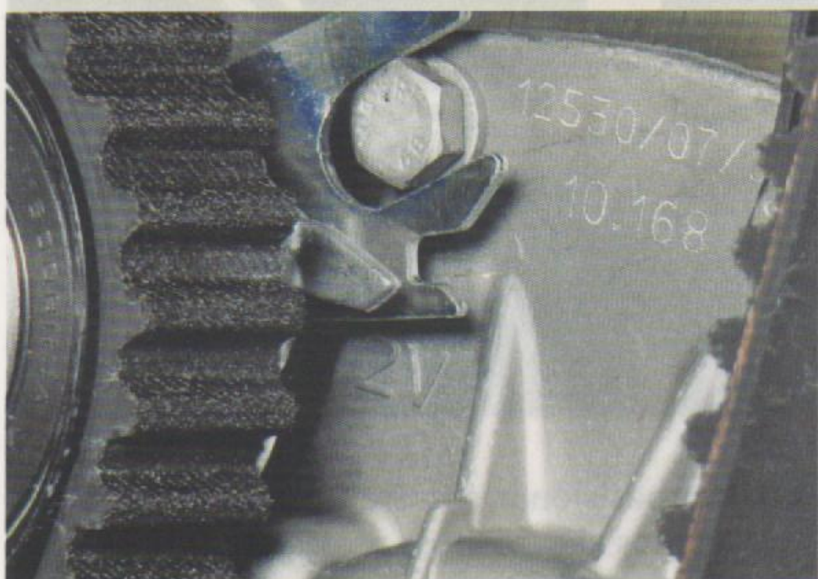
Fig.8 - Posição do ponteiro do tensor
