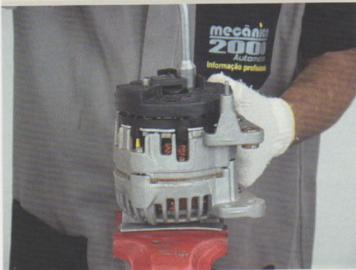
Fig.1 - Remoção da tampa de proteção
