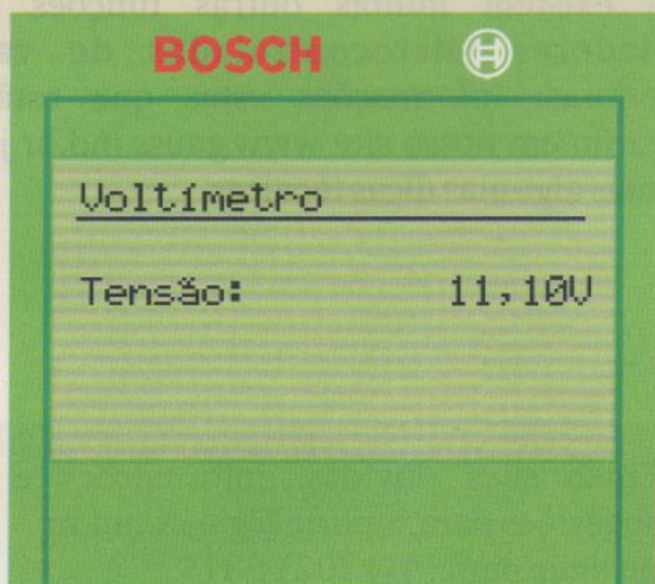
Fig. 2 - Verificação da queda de tensão
