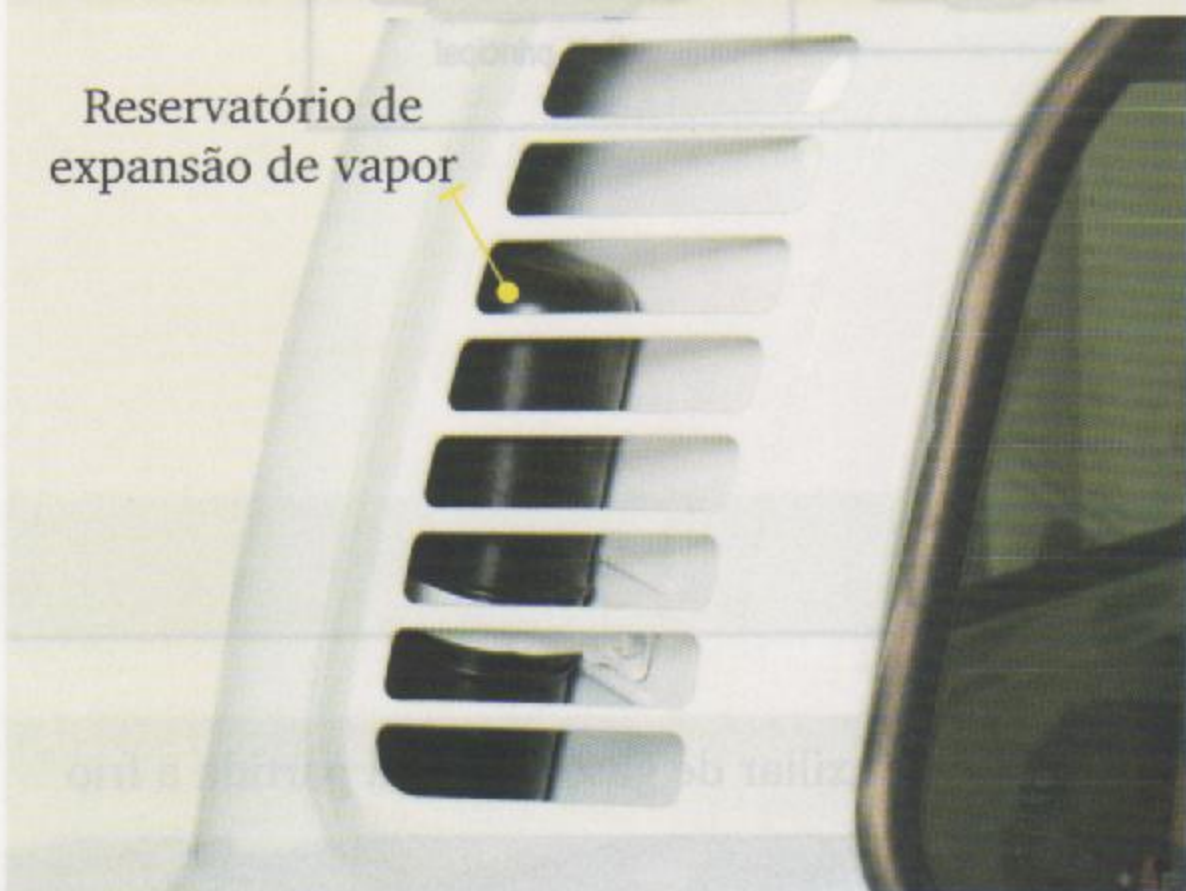
Fig.4b - Localização do reservatório de expansão
