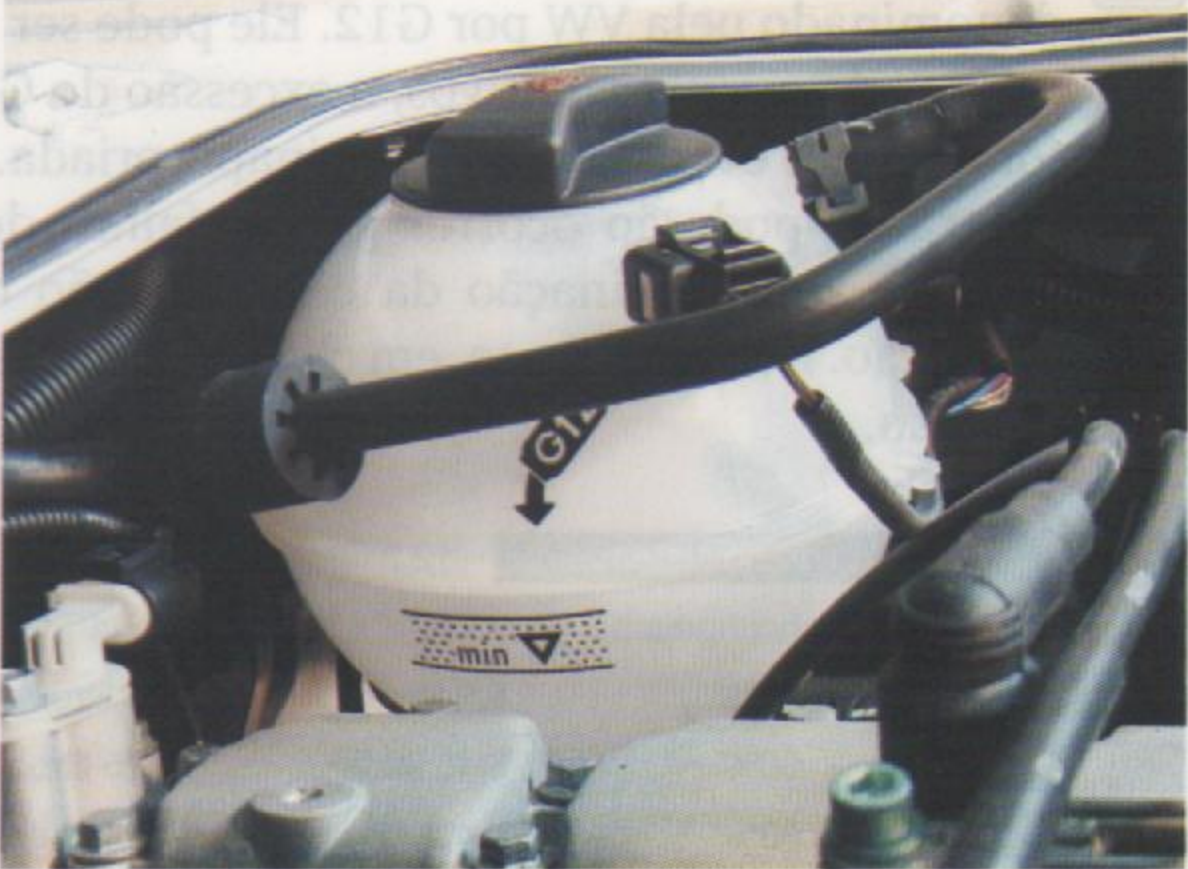
Fig.6 - Marcas de MAX e MIN no reservatório
