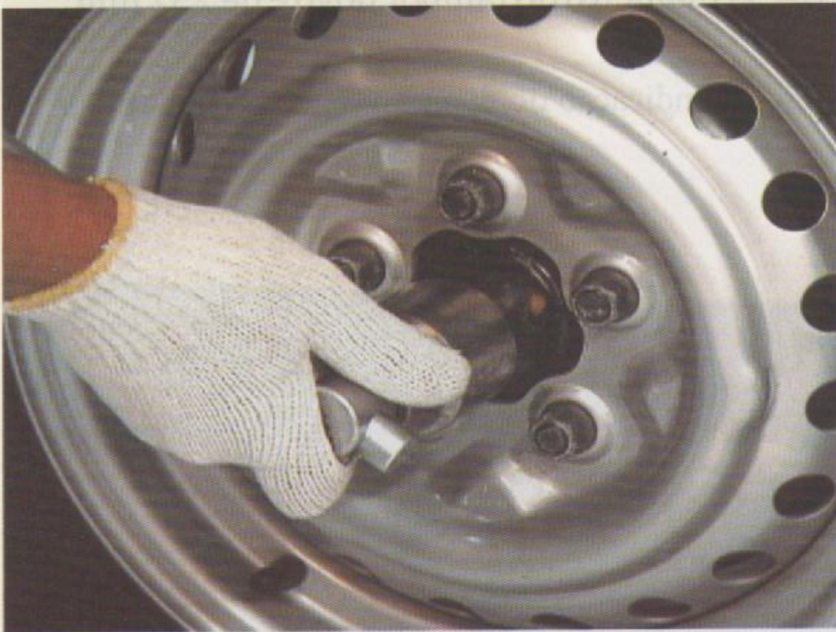
Fig.1 - Desaperto da porca de fixação do cubo
