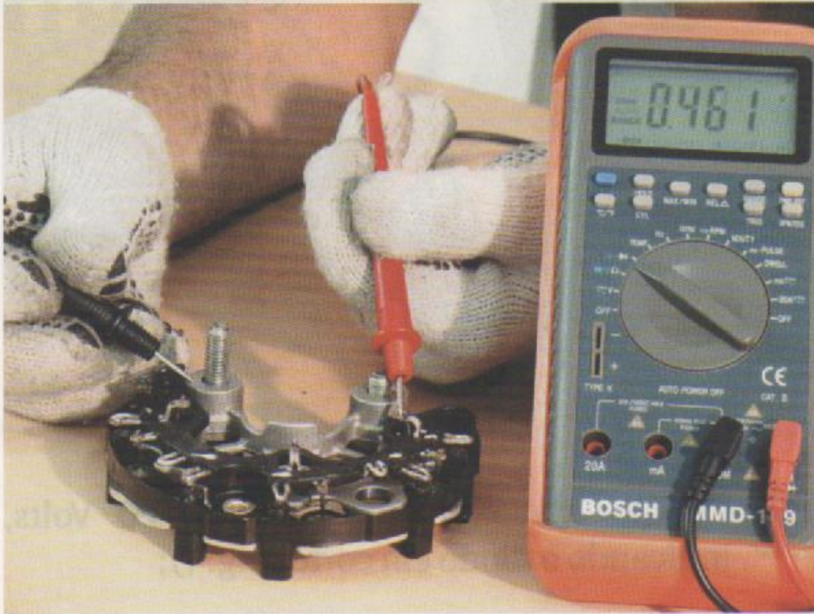
Fig.3 - Multímetro indica diodo conduzindo
