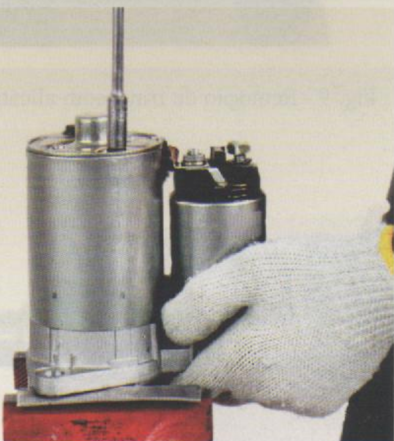
Fig. 1 - Remoção de parafusos de fixação da carcaça
