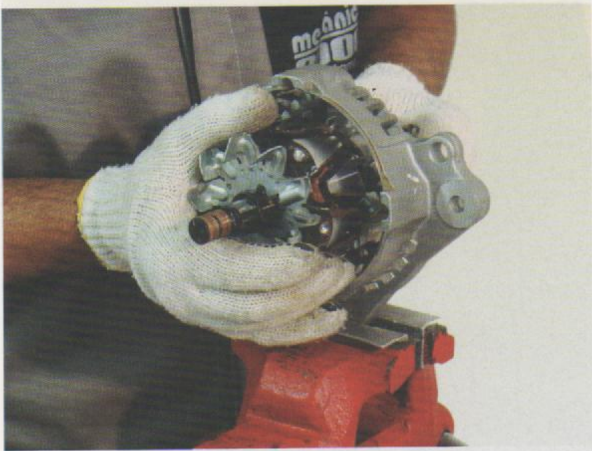
Fig.11 - Remoção do rotor
