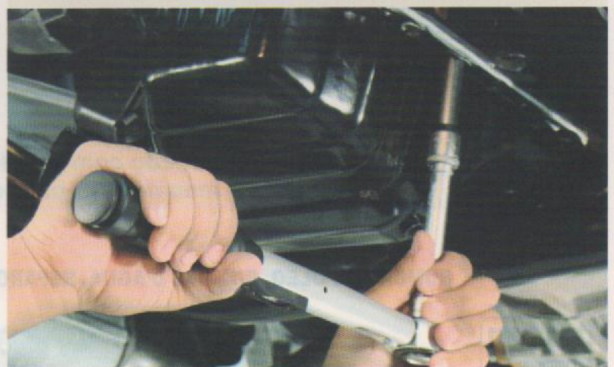
Fig.6 - Aplicação de torque no carter
