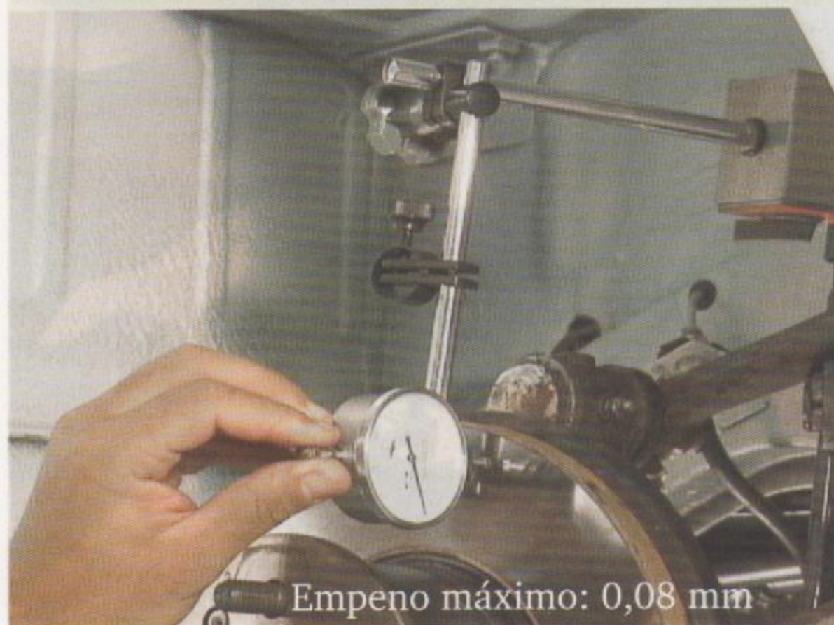
Fig.5 - Medida do empeno máximo do disco
