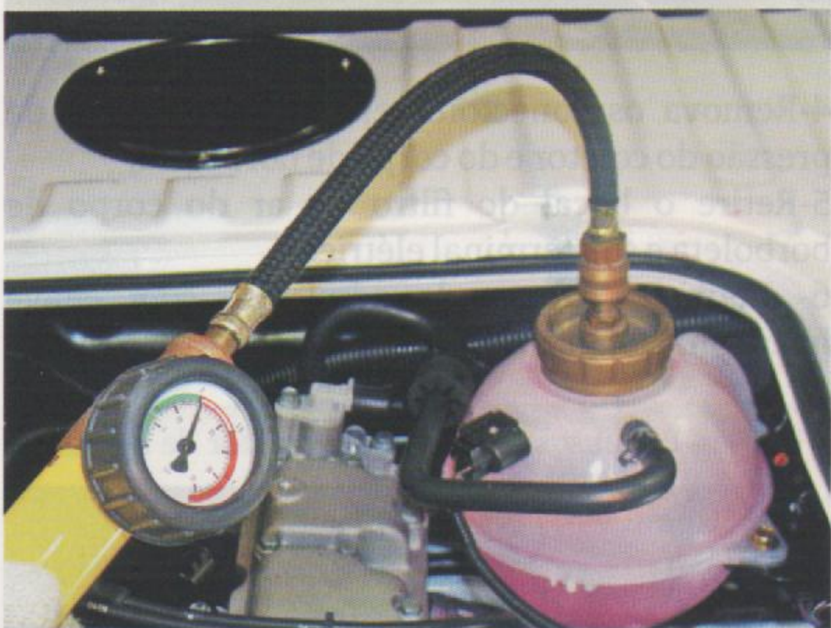
Fig.8 - Pressurização do sistema de arrefecimento
