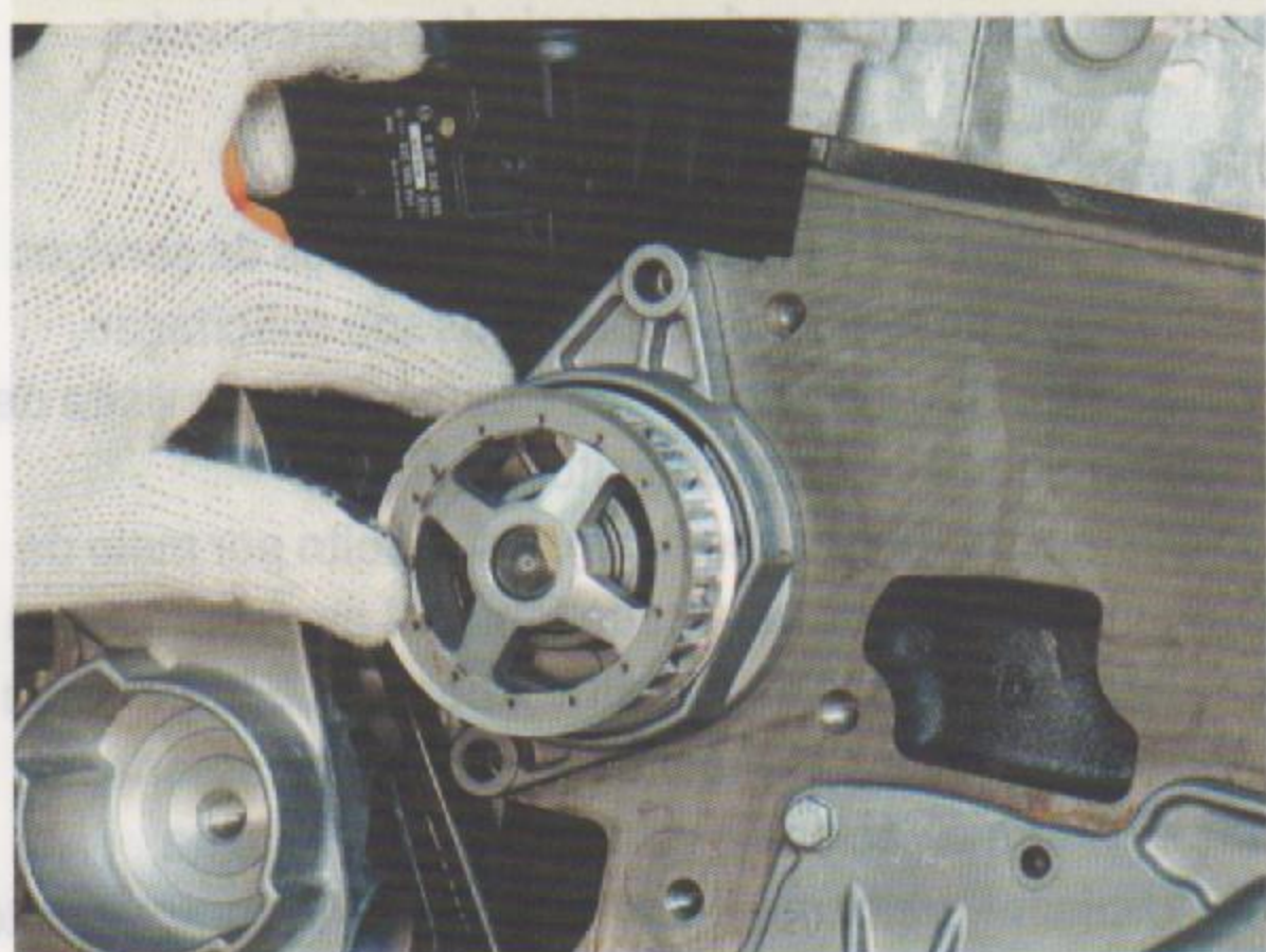
Fig.3 - Acoplamento da bomba no bloco
