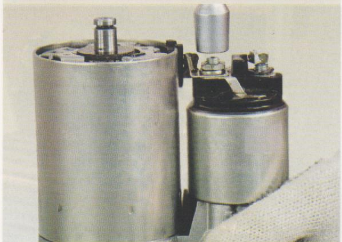
Fig. 3 - Remoção da porca da chave magnética
