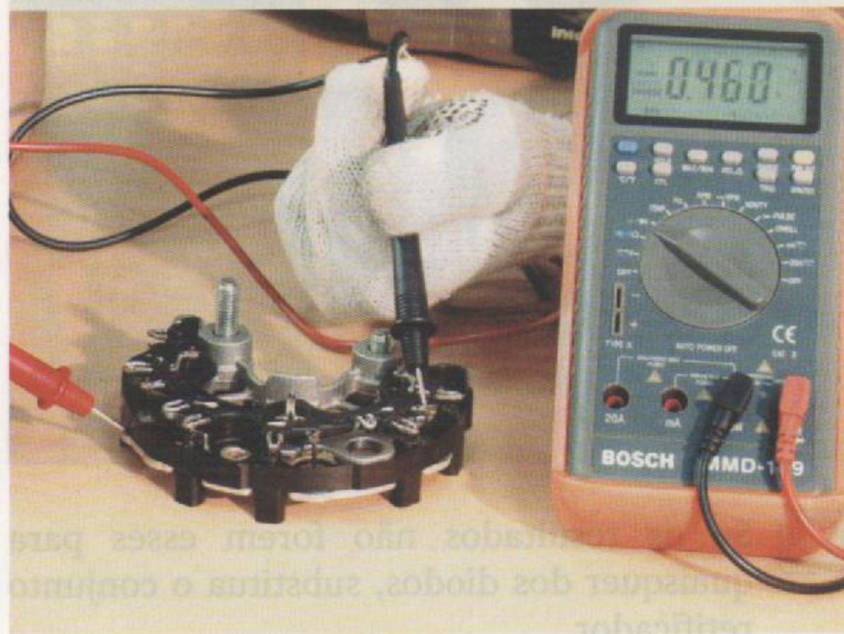
Fig.3 - Multímetro indica diodo conduzindo
