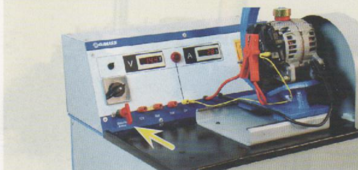
Fig.1 - Chave ligada e motor da bancada acionado
