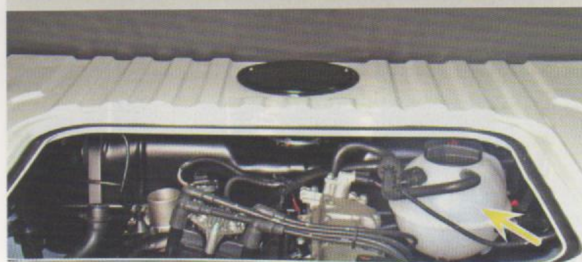
Fig.1 - Localização do reservatório de expansão
