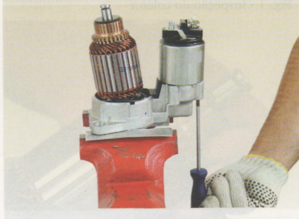
Fig. 5 - Instalação do suporte das escovas
