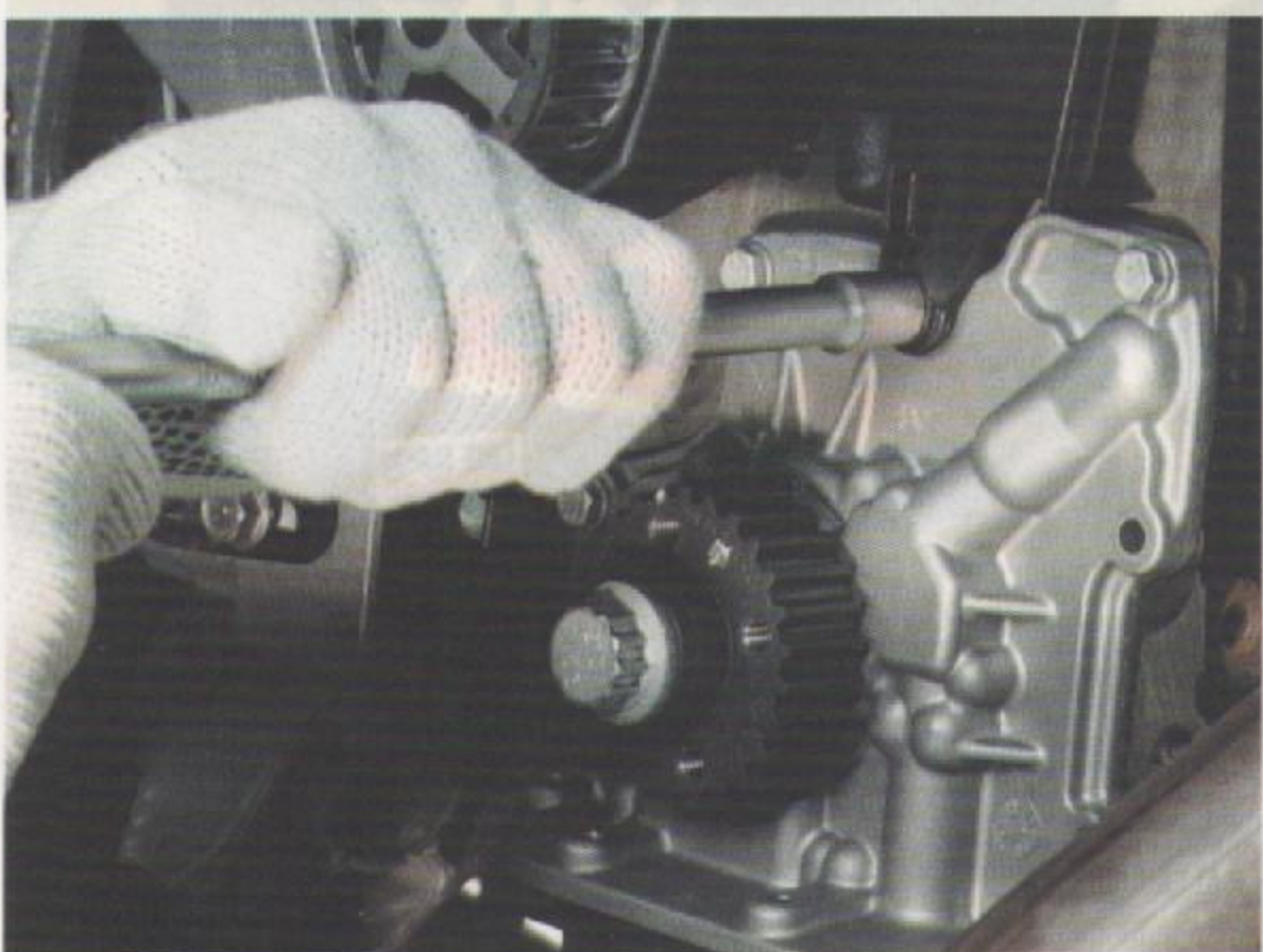
Fig.4 - Remoção do parafuso inferior da proteção
