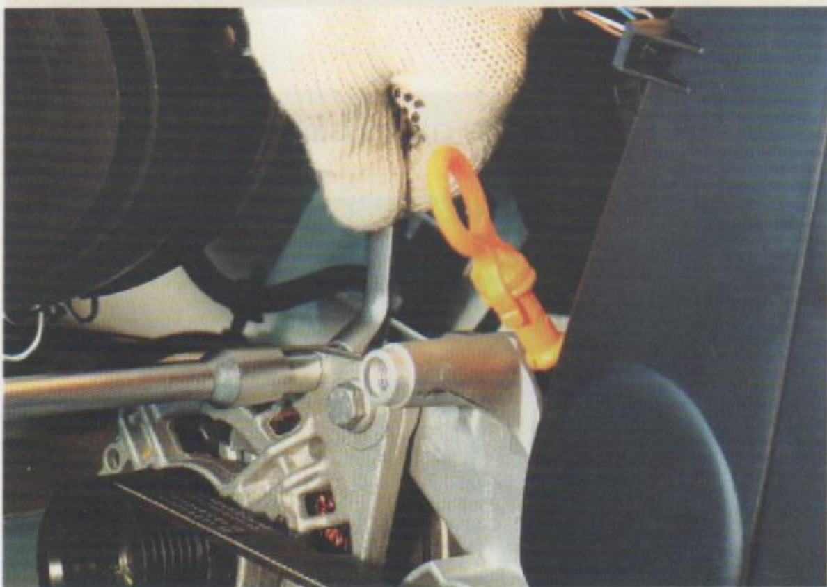
Fig.2 - Instalação dos parafusos espaçadores
