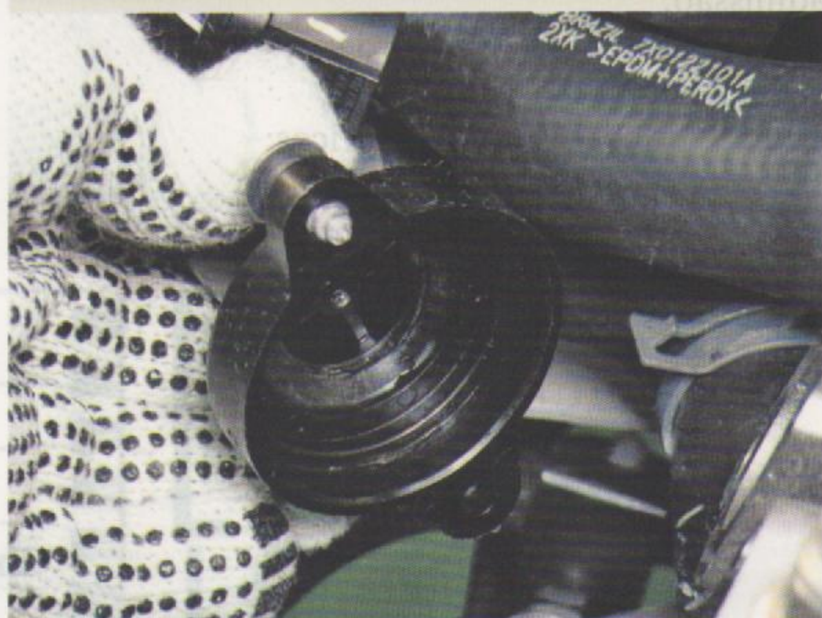
Fig.7b - Carcaça da válvula removida
