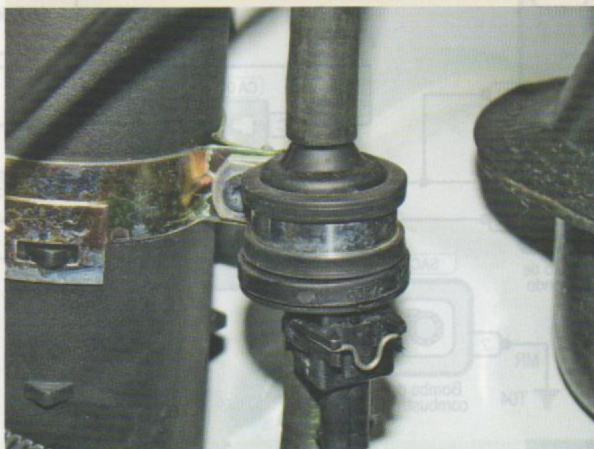
Fig.6 - Válvula de purga do Cânister
