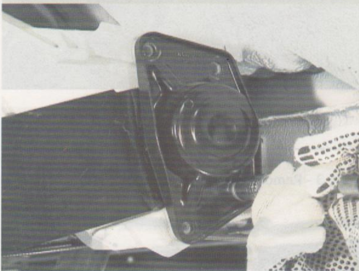
Fig.5 - Remoção dos parafusos da tampa
