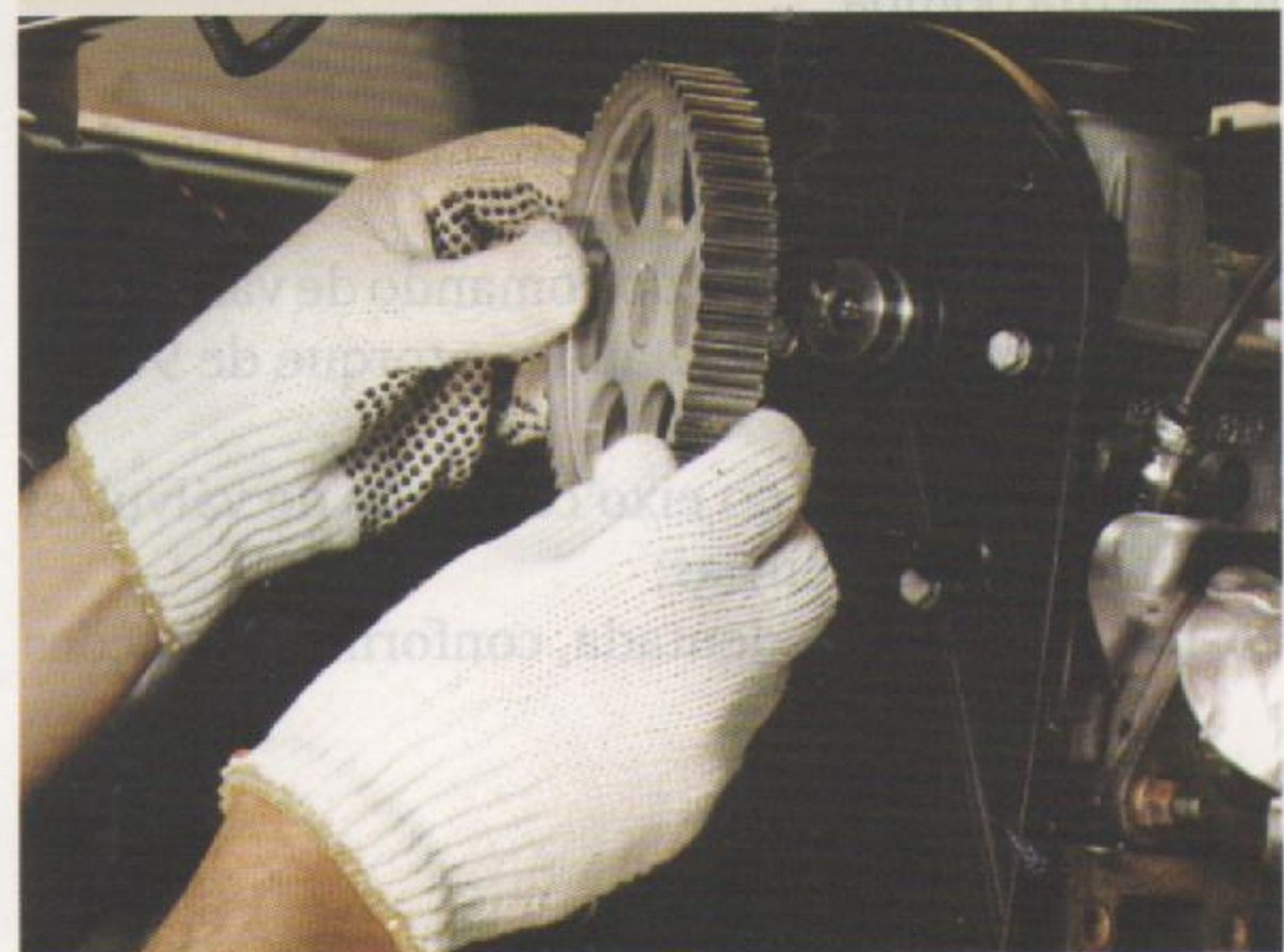
Fig.2 - Remoção da engrenagem do comando
