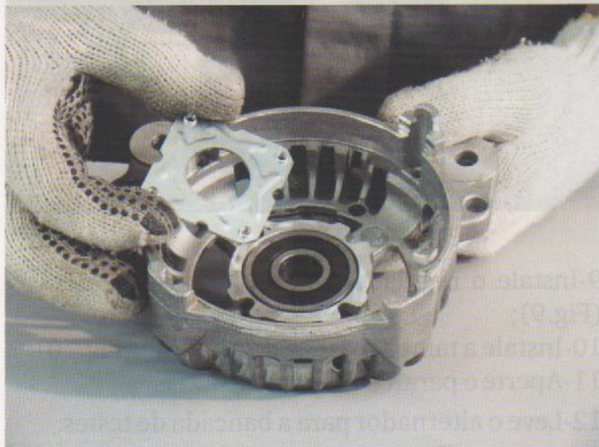
Fig.1- Instalação da proteção do rolamento
