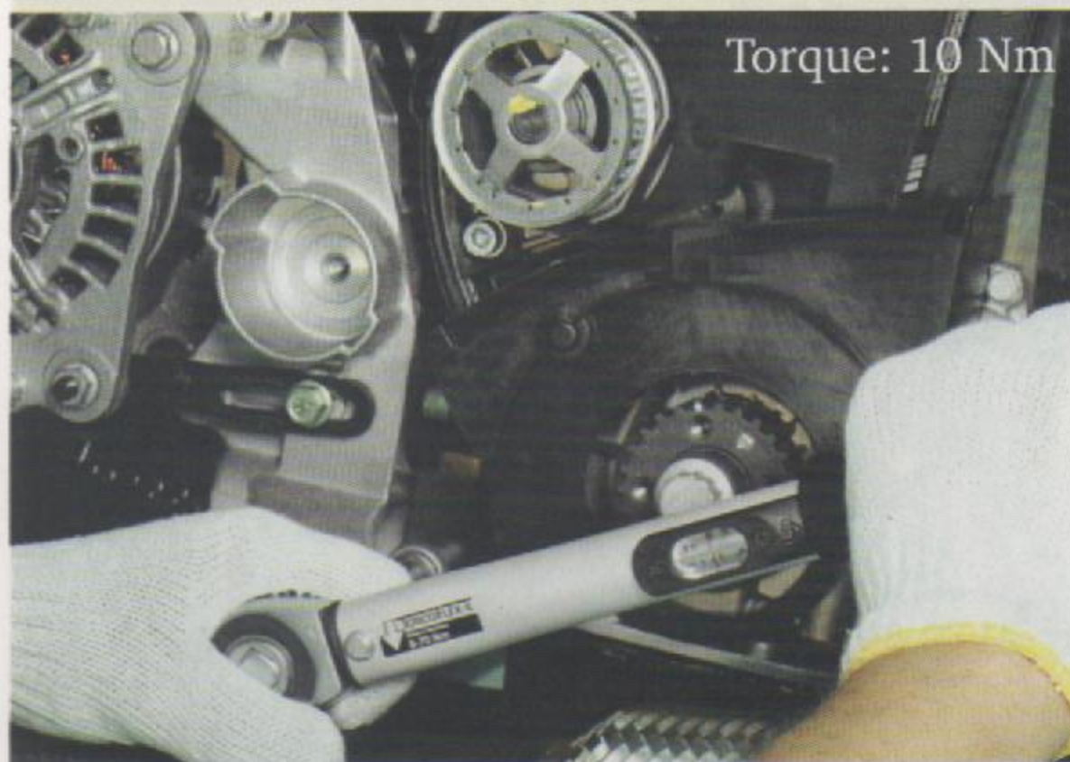
Fig.11 - Aplicação de torque nos parafusos da tampa
