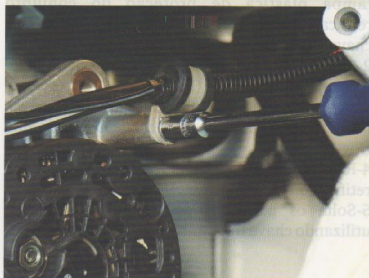
Fig.9 - Remoção da abraçadeira do chicote
