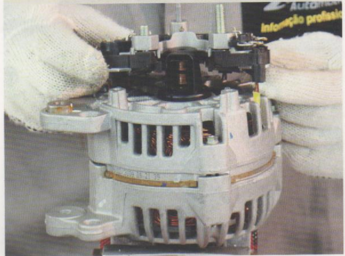
Fig.4 - Remoção do conjunto retificador
