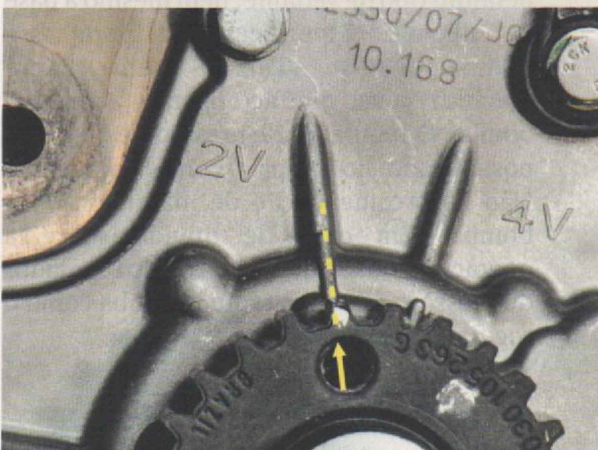
Fig.1 - Posição da engrenagem da manivela
