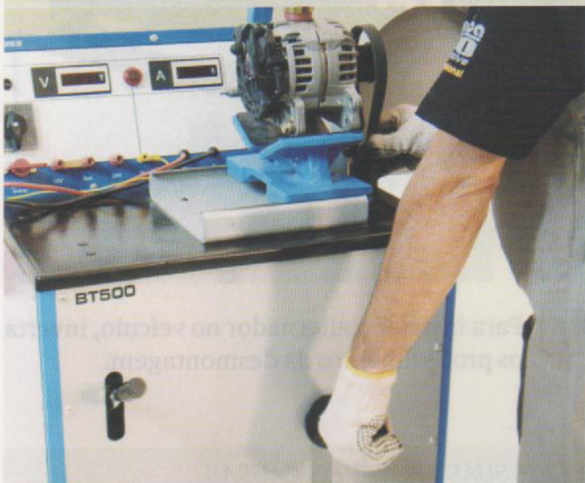
Fig.1 - Instalação da correia do alternador
