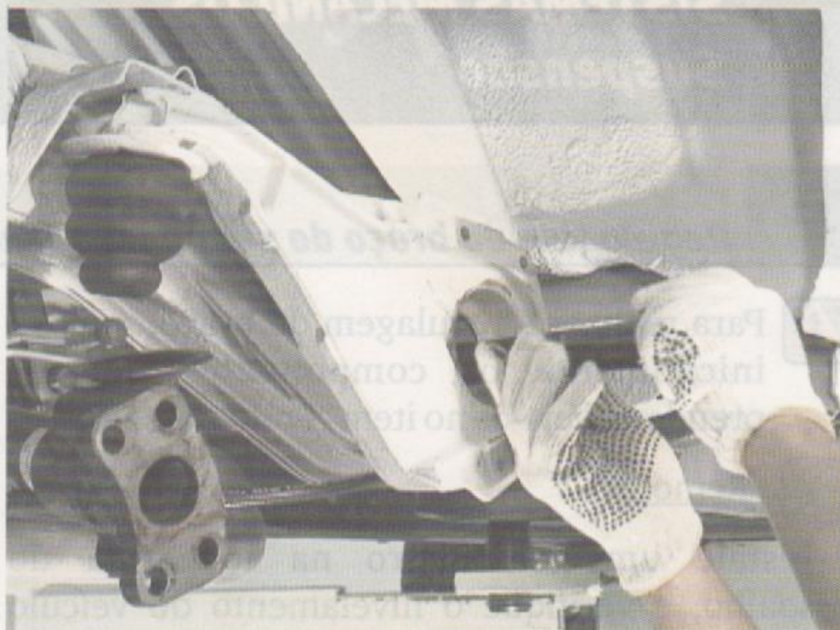
Fig.8 - Remoção da barra de torção
