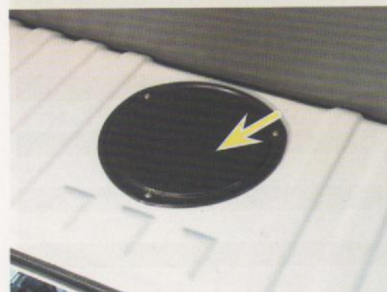
Localização do conjunto da bomba de combustível - SAC
