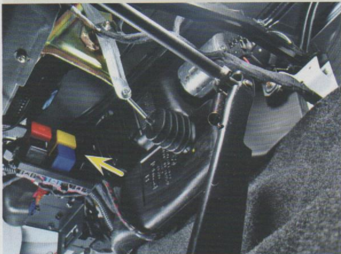
Localização da central de relés
