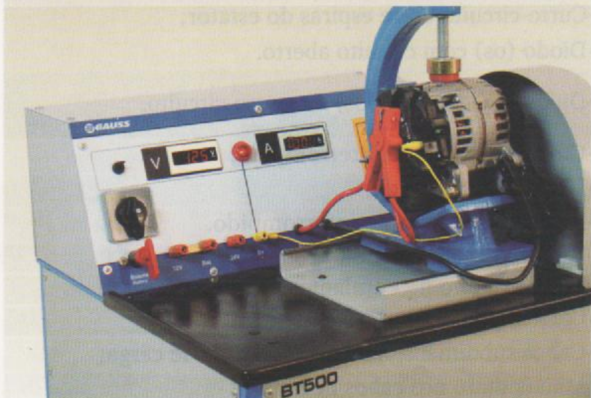
Fig.3 - Instalação dos cabos elétricos
