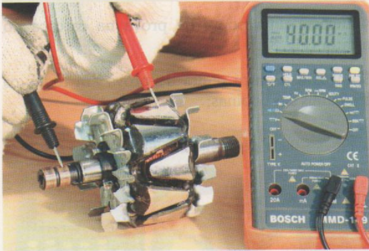
Fig.3 - Teste de isolamento com a carcaça
