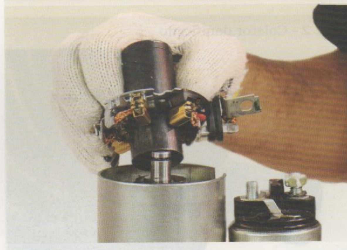
Fig. 6 - Aperto final dos parafusos
