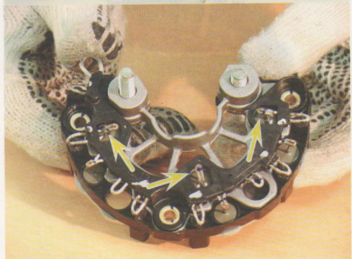
Fig.2 - Identificação dos diodos positivos
