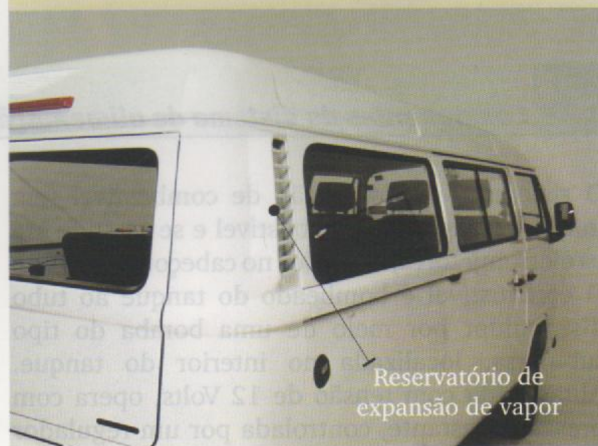
Fig.4a - Localização do reservatório de expansão
