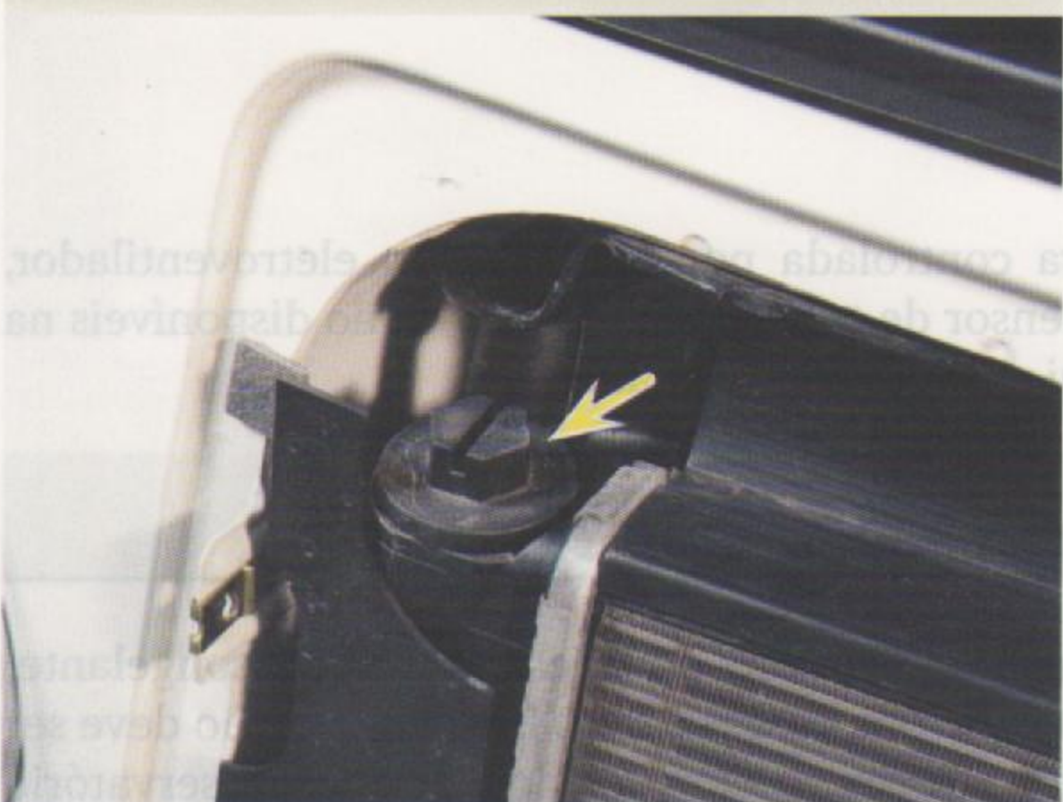
Fig.3 - Localização do parafuso de dreno do radiador
