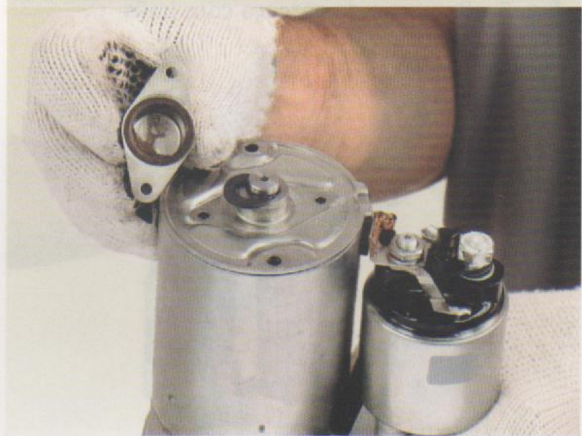
Fig. 2 - Remoção do sistema de travamento
