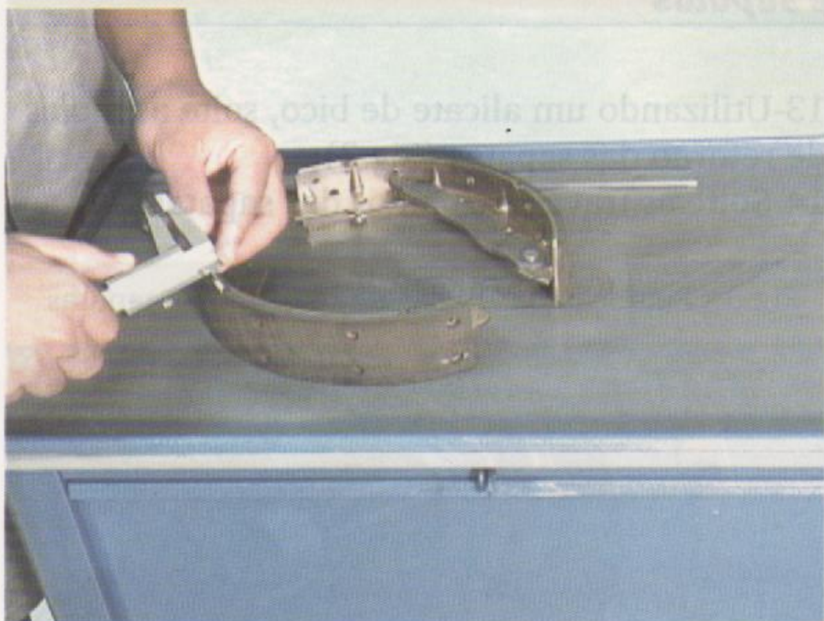
Fig.5 - Espessura mínima da lona: 2,5 mm
