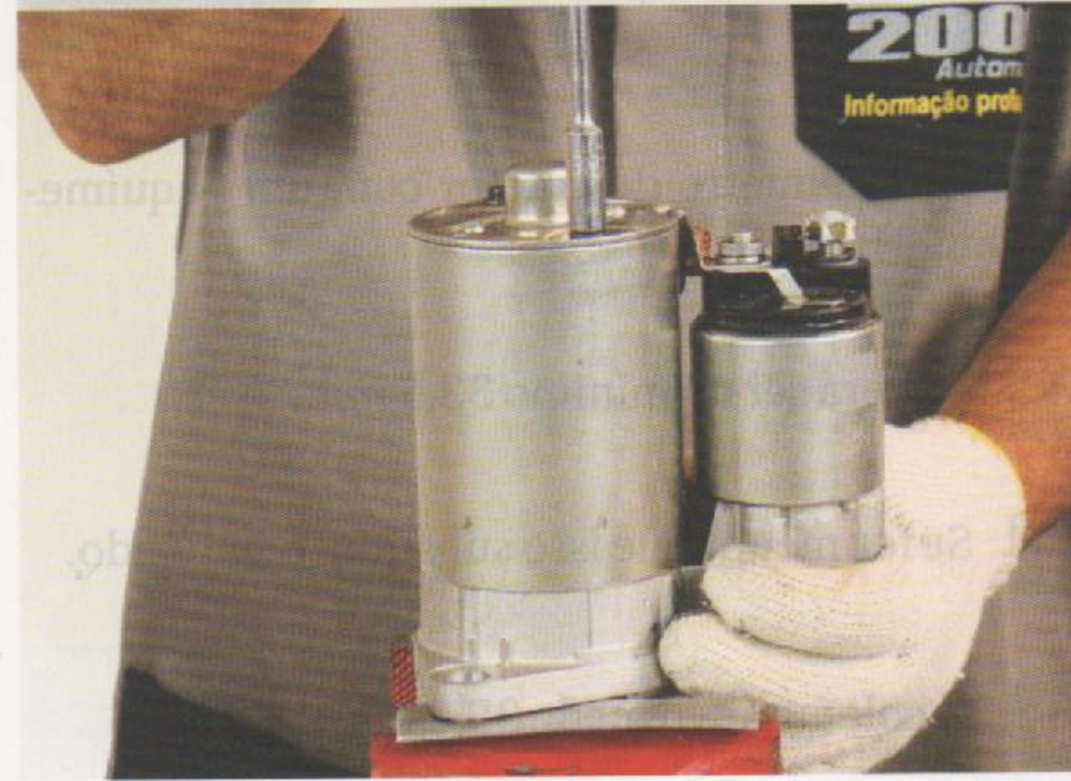
Fig. 6 - Aperto final dos parafusos
