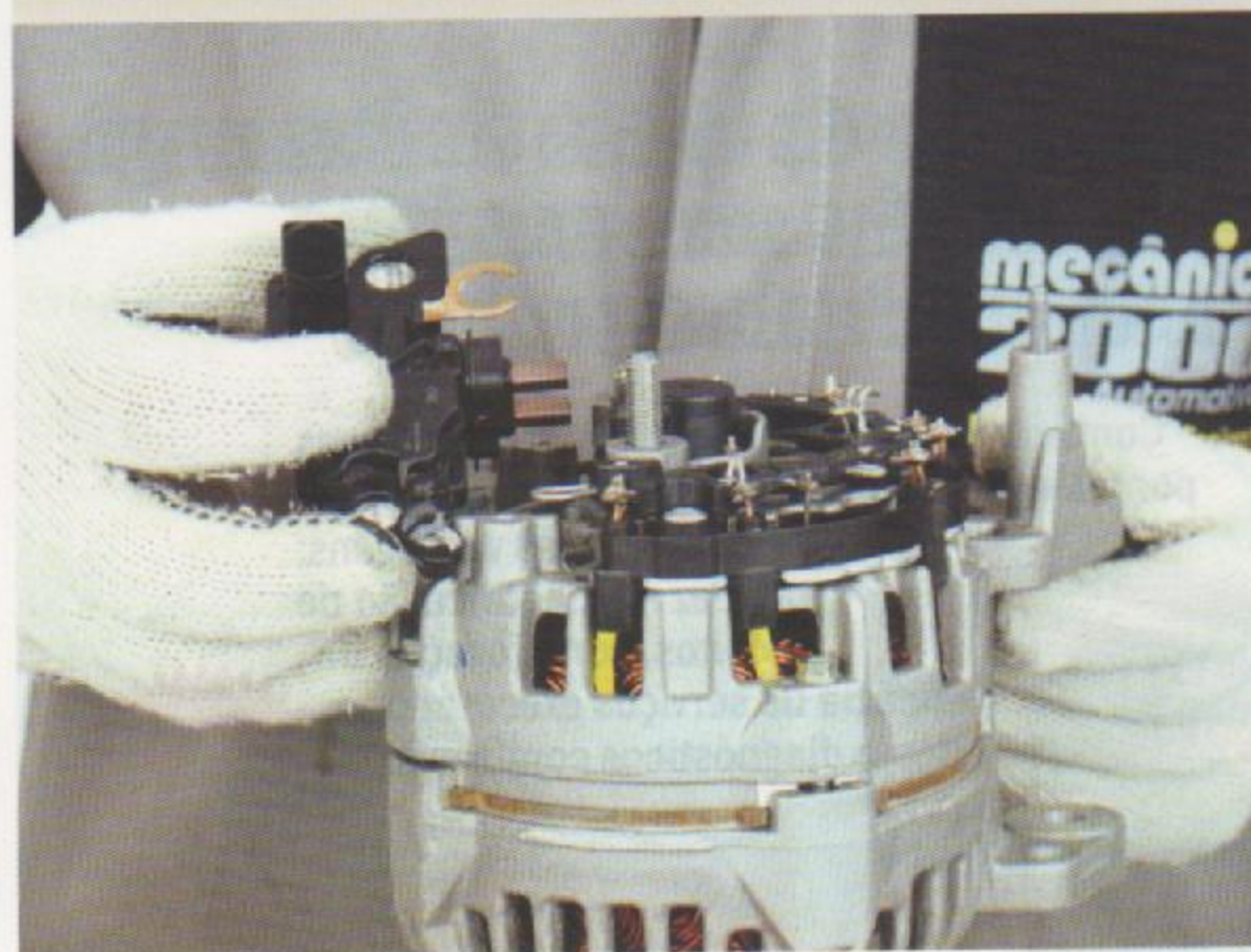
Fig.2 - Remoção do regulador de tensão
