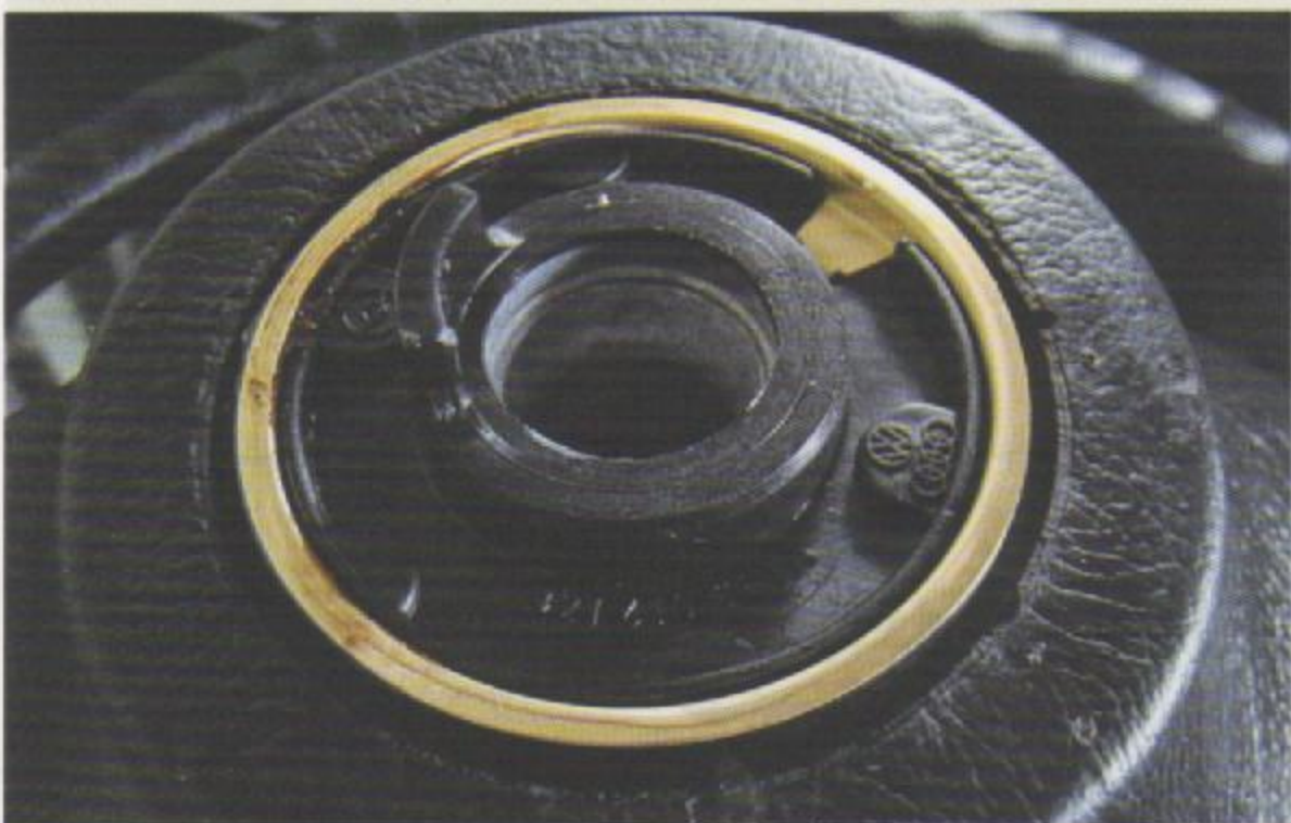
Pista de contato do circuito da buzina, atrás do volante
