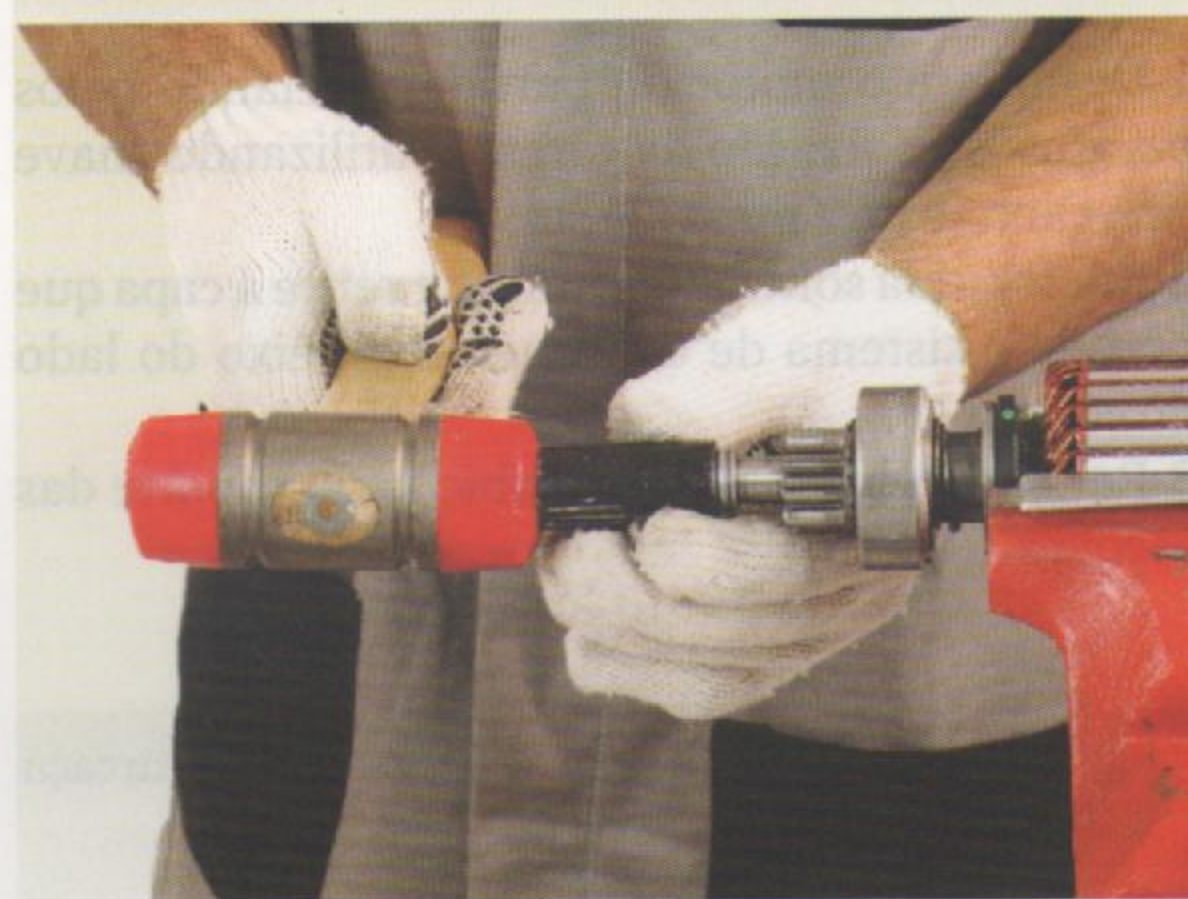
Fig. 8 - Remoção da capa da trava
