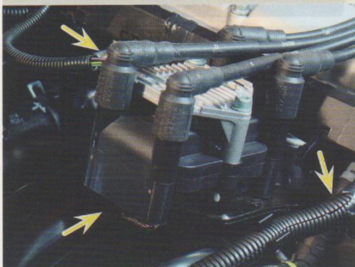
Fig.1 - Parafusos de fixação da bobina
