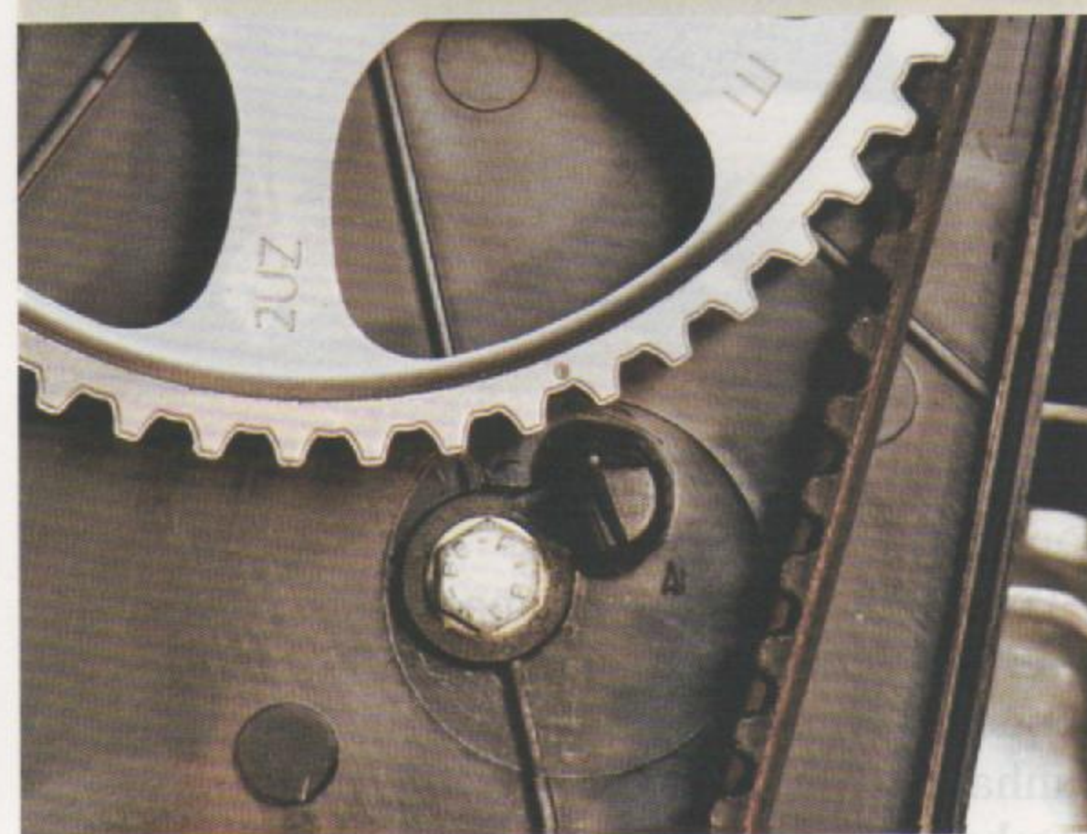
Fig.5 - Posicionamento do comando de válvulas
