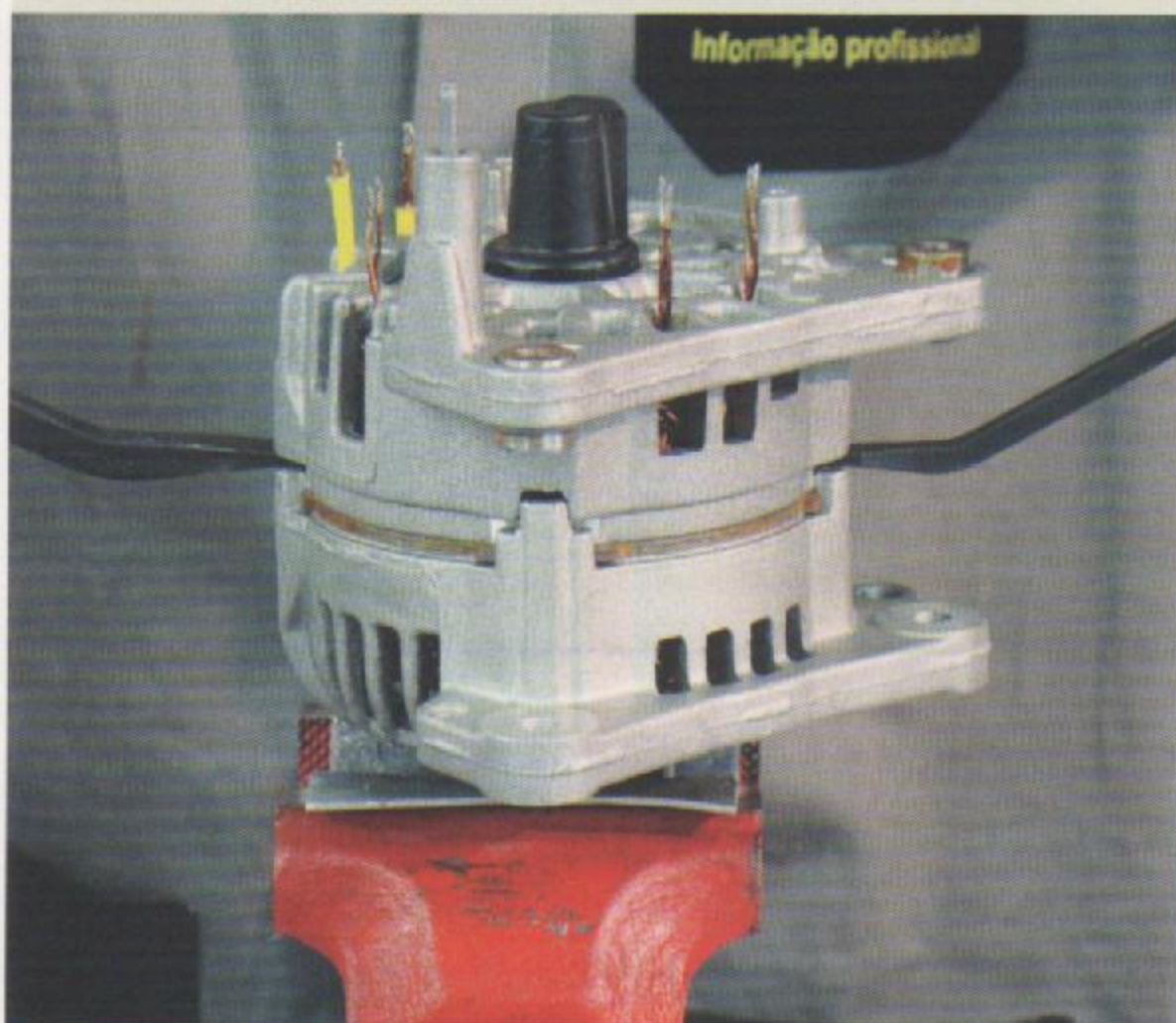
Fig.6 - Separação dos mancais do alternador
