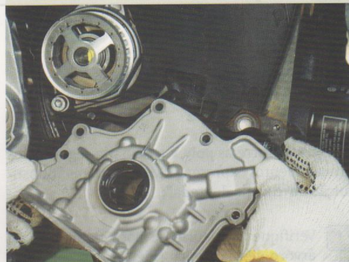
Fig.7 - Remoção da bomba
