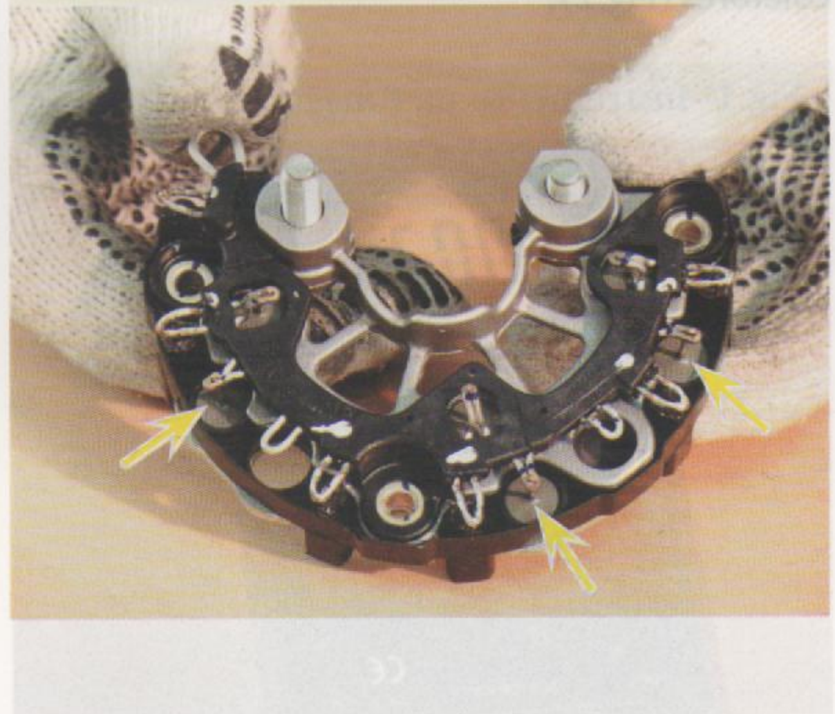
Fig.2 - Identificação dos diodos negativos
