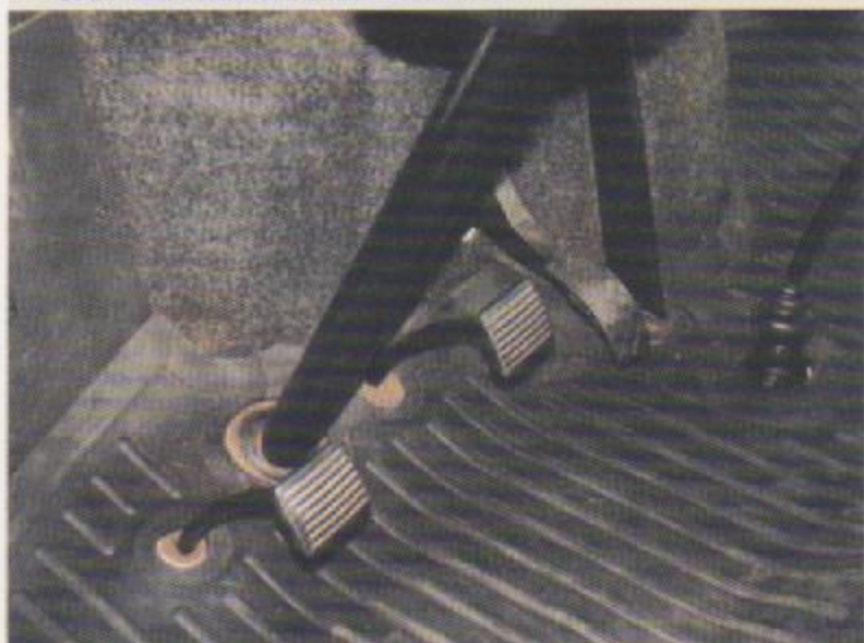
Localização do Sensor do pedal do acelerador - SPA
