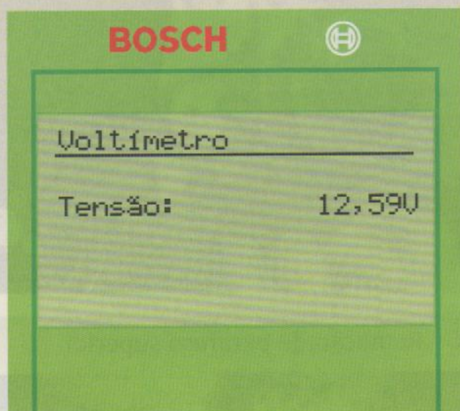
Fig.2 - Valor da tensão estática da bateria
