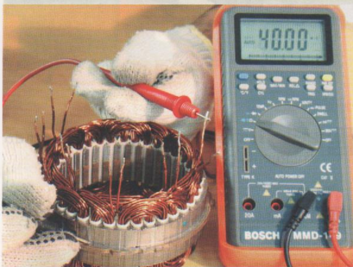
Fig.3 - Teste de isolamento para a carcaça
