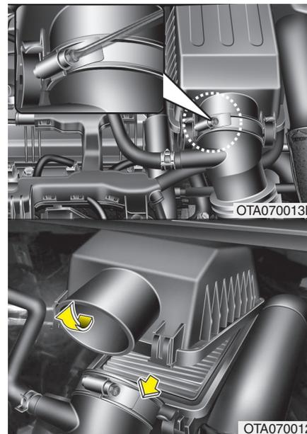
2. Com uma chave de parafusos desaperte a braçadeira do tubo do filtro de ar.
