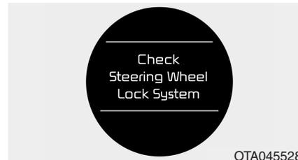
Se o volante não bloquear normalmente quando o botão ENGINE START/ STOP roda para a posição OFF, a luz avisadora acende-se no visor LCD durante 10 segundos. Além disso, o sinal sonoro toca durante 3 segundos e o a luz do botão ENGINE START/STOP pisca durante 10 segundos.
