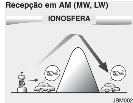
A recepção dos sinais de AM (MW, LW) é, normalmente, melhor do que em FM. Isto deve-se ao facto das ondas de AM (MW, LW) serem transmitidas em baixas frequências. Estas ondas longas, de baixa frequência podem seguir a curvatura da Terra, em vez de seguirem a direito para a atmosfera. Além disso, dão a volta aos obstáculos, assegurando assim uma cobertura mais perfeita.
