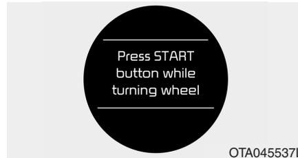
Se ao pressionar o botão ENGINE START/STOP o volante não desbloquear normalmente, a luz avisadora acende-se no visor LCD durante 10 segundos. Além disso, o sinal sonoro faz-se ouvir uma vez e a luz do botão ENGINE START/STOP pisca durante 10 segundos.
