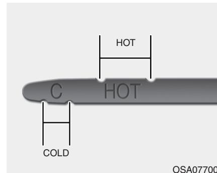
3. Certifique-se de que o nível do fluido está no intervalo com a indicação "HOT" no indicador de nível. Se o nível do fluido estiver abaixo desta indicação, adicione o fluido especificado através do orifício de enchimento. Se o nível do fluido estiver acima desta indicação, drene o fluido em excesso através do orifício de drenagem.
