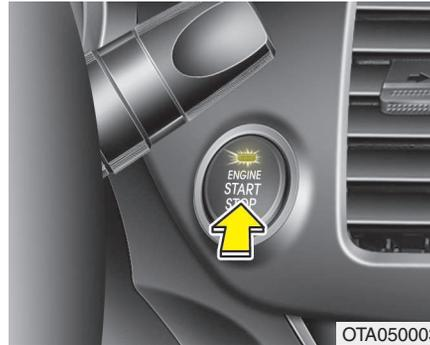
**Ligar o motor com um dispositivo smart key (se instalado)**
