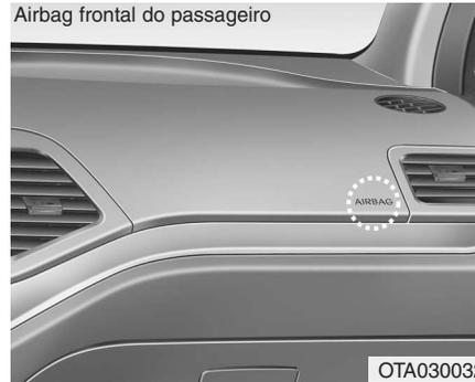
A finalidade do sistema SRS é, num impacto frontal suficientemente forte, oferecer ao condutor e/ou ao passageiro da frente do veículo uma protecção suplementar à oferecida pelo sistema de cintos de segurança.
