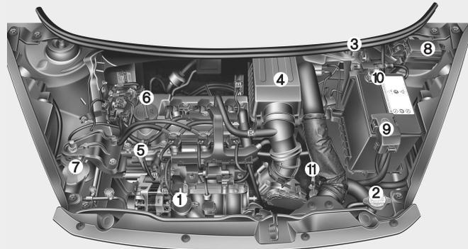
1. Depósito do líquido de refrigeração do motor
