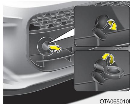
**Gancho de reboque removível (frente, se instalado)**
