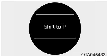
Se tentar desligar o motor sem o selector de mudanças na posição P (park), o botão ENGINE START/STOP roda para a posição ACC. Se premir mais uma vez o botão, este regressa à posição ON. A luz avisadora acende-se no visor LCD durante aproximadamente 10 segundos para indicar que deve pressionar o botão ENGINE START/ STOP com o selector de mudanças na posição P (park).
