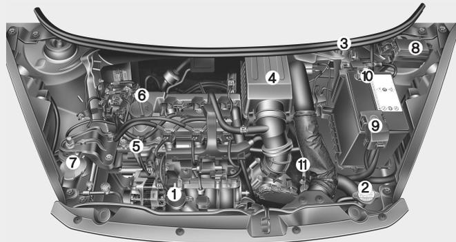
1. Depósito do líquido de refrigeração do motor.....7-29
