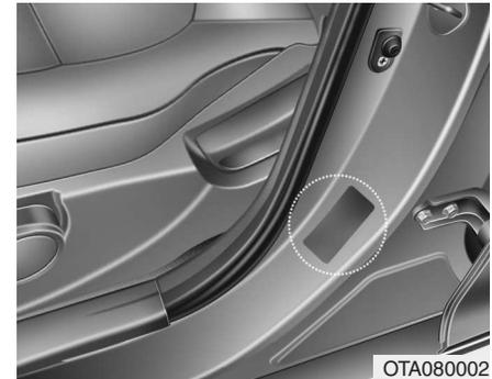
O número de identificação do veículo (VIN) é indicado na etiqueta de certificação do veículo, colocada no pilar central do lado do condutor (ou do passageiro da frente).
