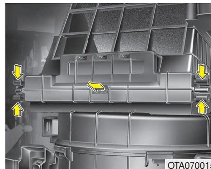
2. Retire a tampa do filtro de ar do sistema de controlo da climatização, carregando no respectivo fecho situado de ambos os lados da tampa.
