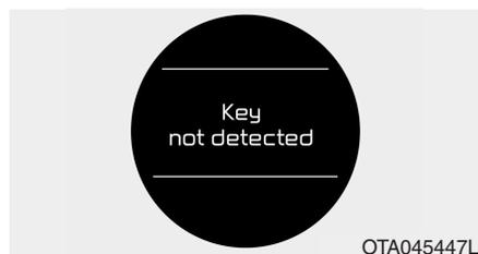
Se o dispositivo Smart Key não estiver dentro do veículo ou não for detectado e se o botão ENGINE START/STOP for pressionado, acende-se um aviso no visor LCD durante 10 segundos. Além disso, a luz indicadora do imobilizador de arranque pisca durante 10 segundos.
