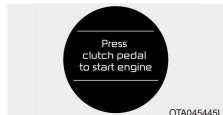
Se o botão para ligar/desligar o motor passar para a posição ACC duas vezes por ser pressionado repetidamente sem carregar no pedal da embraiagem, o aviso acende-se no visor LCD durante cerca de 10 segundos para indicar que deve carregar no pedal da embraiagem para ligar o motor.
