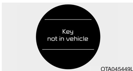
Se o dispositivo Smart Key não estiver dentro do veículo e se alguma porta for aberta ou fechada com o botão ENGINE START/STOP na posição ACC, ON ou START, a luz avisadora acende-se no visor LCD. O sinal sonoro soa durante 5 segundos sempre que o dispositivo Smart Key não se encontra dentro do veículo e a porta está fechada.
