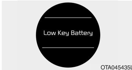
Se o botão ENGINE START/ STOP rodar para a posição OFF devido à pilha do dispositivo Smart Key no veículo estar a ficar sem carga, acende-se uma luz avisadora no visor LCD durante 10 segundos e o sinal sonoro soa uma vez. Substitua pilha por uma nova.
