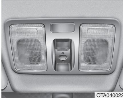
Se o seu veículo estiver equipado com um tecto de abrir, pode fazê-lo deslizar ou incliná-lo com o manípulo de comando situado na consola superior.
