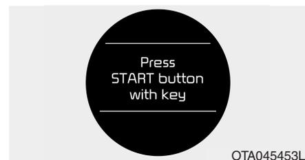
Se pressionar o botão de ENGINE START/STOP enquanto está iluminado o aviso "Key not detected (Smart Key Não Detectada)", surge durante 10 segundos no visor LCD a mensagem (Premir Start com Smart Key). Além disso, a luz indicadora do imobilizador de arranque pisca durante 10 segundos.
