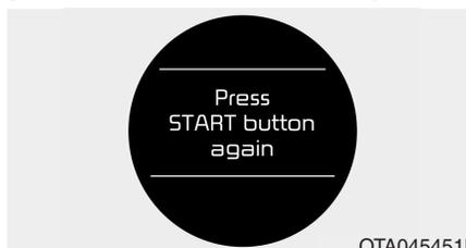
Se não conseguir fazer funcionar o botão ENGINE START/STOP quando ocorre um problema com o respectivo sistema, a luz avisadora acende-se durante 10 segundos e o sinal sonoro faz-se ouvir de forma continua para indicar que pode ligar o motor de arranque pressionando mais uma vez o botão ENGINE START/STOP.
