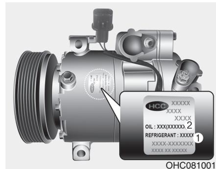
A etiqueta do compressor informa-o sobre o tipo de compressor que o seu veículo tem equipado, nomeadamente o modelo, o número da peça sobressalente, o número de produção, o líquido refrigerante (1) e o óleo refrigerante (2).
