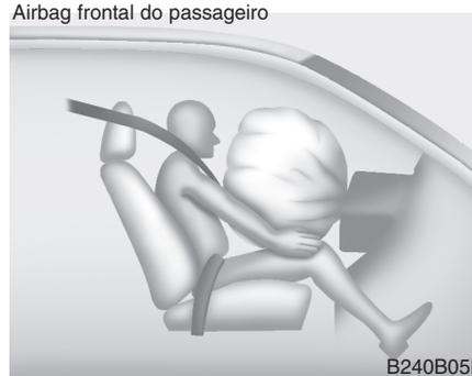
O enchimento total de um airbag, juntamente com a actuação de um cinto de segurança correctamente colocado, atenua o movimento para a frente do condutor ou do passageiro da frente, reduzindo o risco de lesões na cabeça e no tórax.
