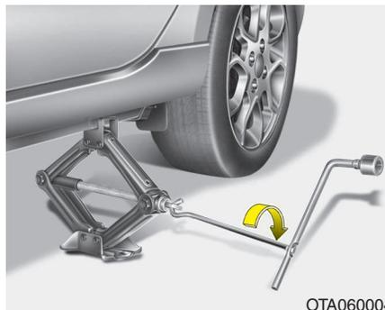
8. Introduza o rabo do macaco no macaco e rode-o no sentido dos ponteiros do relógio, levantando o veículo até o pneu ficar mesmo acima do chão, a uma altura de aproximadamente 30 mm. Antes de retirar as porcas da roda, certifique-se de que o veículo está estável e que não há possibilidade de se mover ou deslizar.
