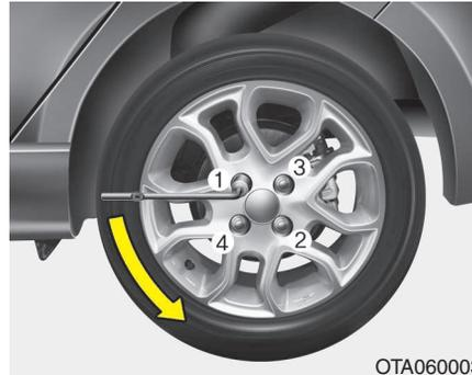
6. Desaperte as porcas da roda com uma volta de cada vez no sentido contrário ao dos ponteiros do relógio, mas não retire nenhuma porca até o pneu ser levantado do chão.
