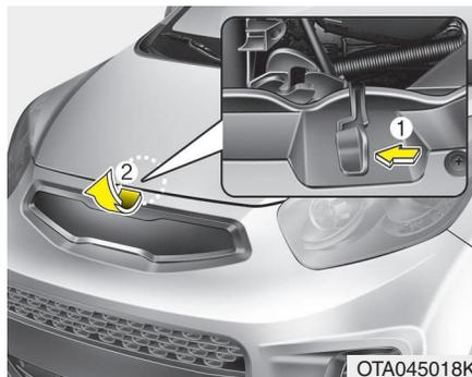
2. Vá à dianteira do veículo, levante um pouco o capô, puxe o fecho secundário (1) central e levante o capô (2).
