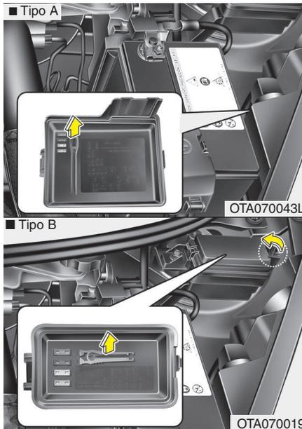
3. Com a ferramenta de remoção existente no painel de fusíveis do compartimento do motor, puxe o fusível suspeito a direito para fora.
