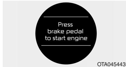
Se o botão ENGINE START/ STOP rodar para a posição ACC duas vezes, por pressionar o botão repetidamente sem carregar no pedal do travão, acende-se uma luz avisadora no visor LCD durante 10 segundos para indicar que deve carregar no pedal do travão para ligar o motor de arranque.
