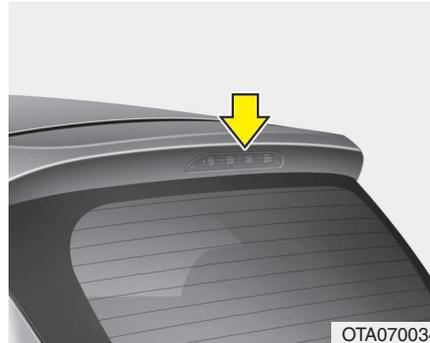
**Substituição da luz de travagem em posição elevada (se instalada)**
