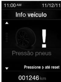
O sistema iTPMS assinala ao condutor a eventual presença de uma condição de pressão de enchimento diferente da condição no momento do reset. Se esta descer abaixo do limite de advertência por qualquer motivo, incluindo os efeitos da baixa temperatura e a normal perda de pressão do pneu.
