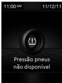
Se o sistema detectar que um ou mais pneus estão com pressão abaixo da condição inicial de monitoramento do sistema (realizada após a calibração e reset), deverá indicar através de um pop-up na tela seguido pelo acendimento da luz-espia (ⓘ) no quadro de instrumentos.
