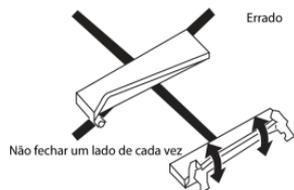
Encaixar o plástico costurado na lateral da lona no perfil, fazendo uma alavanca de tensionamento **I**, iniciando o encaixe pelas extremidades **J** e finalizando pela região central **K**.
