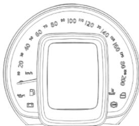
As quilometragens parcial e total, podem ser visualizadas no display. A quilometragem parcial é visualizada na função **TRIP**, situada na extremidade da alavanca direita ou, conforme o veículo, através do menu do computador de bordo.
