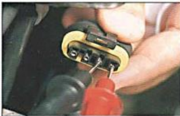
Fig. 3.1. Medida da tensão de alimentação da resistência de aquecimento.
