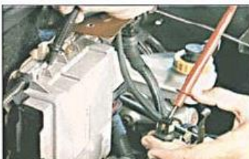
Fig. 1.2. Medida da tensão de alimentação da válvula CANP.
