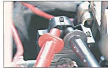
Fig. 2.1. Medida de resistência da válvula CANP.
