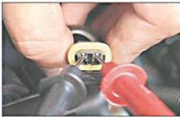
Fig. 4.2. Exemplo de verificação de curto-circuito no chicote da bobina (entre os bornes 1 e 2).
