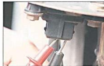
Fig. 3.2. Medida de resistência entre os bornes 2 e 3 do MAP.
