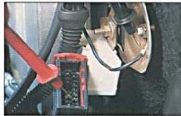
Fig. 2.1. Medida da tensão entre o borne 3 do chicote do relé duplo e a massa.
