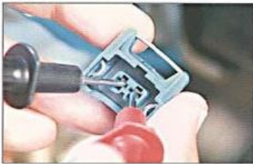
Fig 2.1. Medida da tensão de alimentação do sensor ECT.
