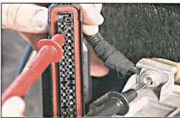
Fig. 2.5. Medida da tensão de alimentação do MC.
