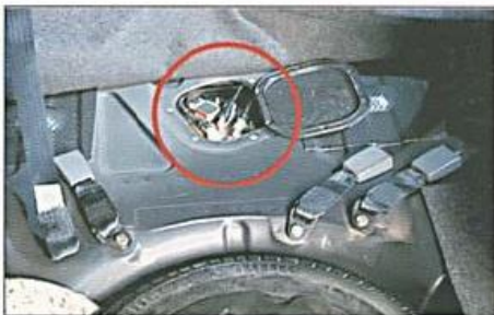
Fig. A. Localização da bomba elétrica de combustível, abaixo do banco traseiro.
