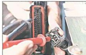
Fig. 4.1. Exemplo de verificação de continuidade no chicote do MAP (entre os bornes 2 do sensor e 16 do MC).
