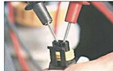
Fig. 3.2. Verificação de curto-circuito no chicote da válvula CANP.
