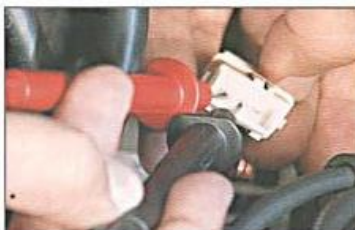
Fig. 1.1. Medida da resistência do sensor ESS.
