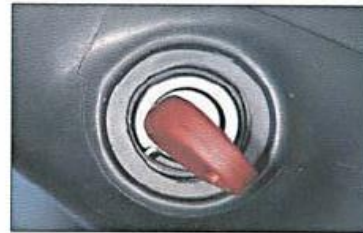
Fig. 2.2. Chave mestra em posição STOP.
