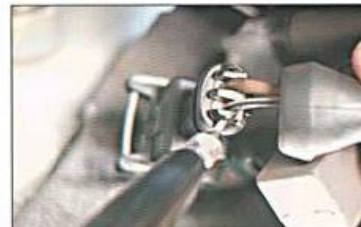
Fig. 1.1. Posicionamento da caneta de polaridade.
