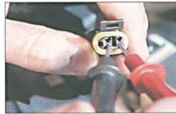
Fig. 2.3. Verificação de curto-circuito no chicote da bomba de combustível.
