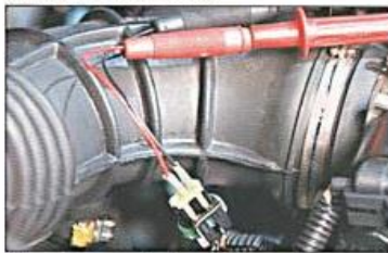
Fig. 4.2. Exemplo de verificação de curto-circuito no chicote do TPS (entre os bornes 1 e 2 do terminal elétrico do sensor).
