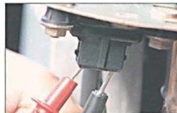
Fig. 3.3. Medida da resistência entre os bornes 1 e 3 do MAP.
