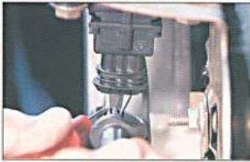
Fig. 1.1. Medida da tensão de resposta do MAP.
