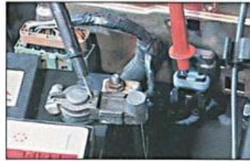
Fig. 1.5. Medida da tensão entre o soquete do fusível de 15A e a massa.
