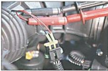
Fig. 3.2. Exemplo de verificação de curto-circuito no chicote do IAC (entre os bornes 1 e 2 do terminal elétrico do IAC).
