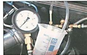
Fig. 6.b. Recipiente para coleta de combustível.
