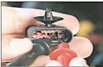
Fig. 2.1. Medida da resistência de aquecimento do sensor HEGO.
