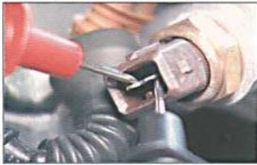
Fig. 3.1 . Medida da resistência do sensor ACT.
