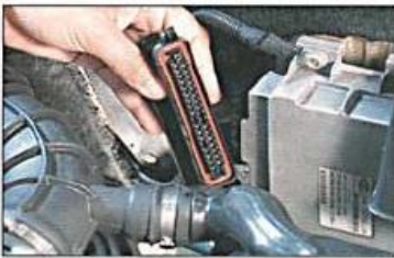
Fig. 2.a. Terminal elétrico do MC.
