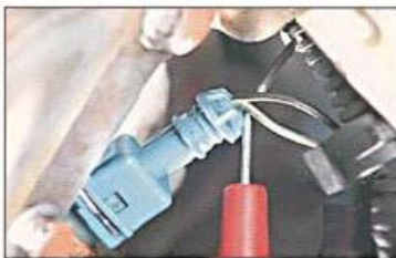
Fig 1.1. Medida da tensão nominal no sensor ECT.
