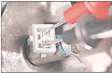
Fig. 2.1. Medida da resistência do eletroinjeter.
