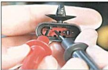
Fig. 1.1. Medida de tensão de resposta do sensor HEGO.
