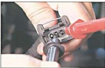
Fig. 2.1. Medida da tensão de alimentação do MAP.
