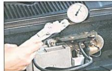
Fig. 1.a. Vacuômetro instalado na mangueira do sensor MAP.
