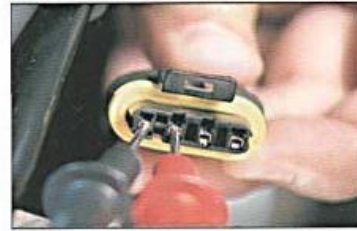
Fig. 4.2. Exemplo de verificação de curto-circuito no chicote do sensor HEGO (entre os bornes 1 e 2 do terminal elétrico do sensor HEGO).
