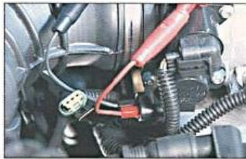
Fig. 3.2. Medida da resistência entre os bornes 1 e 3 do sensor.
