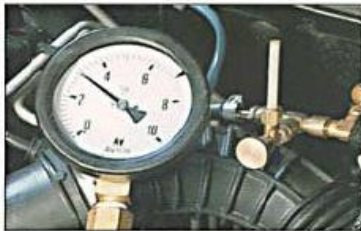
Fig. 4.a. Manômetro instalado na linha de pressão.
