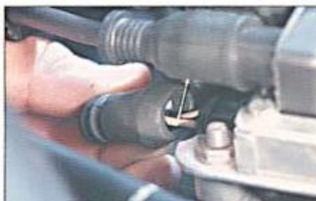
Fig. 1.2. Posicionamento da caneta de polaridade: no borne 2 do chicote da bobina.
