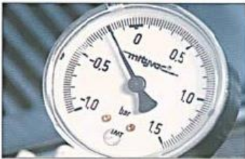
Fig. 1.2. Depressão de 0,2 bar aplicada no MAP.
