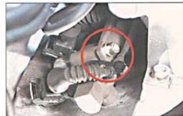
Fig. 5.3. Parafusos de remoção do tubo distribuidor.
