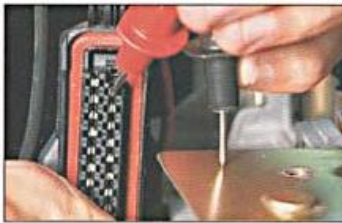
Fig. 1.3. Medida da tensão de alimentação do MC (saída do relé duplo).
