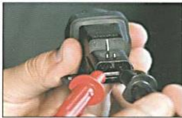
Fig. 3.1. Verificação da continuidade do interruptor inercial.
