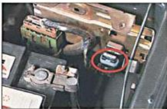
Fig. 1.4. Localização do fusível de 15A: fixado sob um protetor plástico, no suporte da caixa da roda dianteira esquerda.
