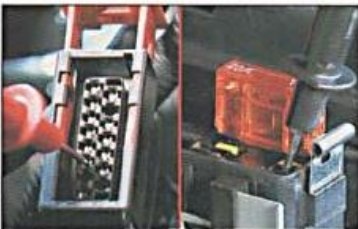
Fig. 4.2. Exemplo de verificação de continuidade no chicote (entre o soquete do fusível EFI 30A e o borne 3 do terminal elétrico do relé duplo).
