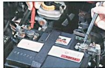
Fig. 1.2. Medida da tensão da bateria.
