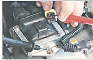
Fig. 2.3. Medida da tensão de alimentação da bobina A.
