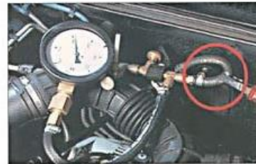
Fig. 5.1. Obstrução do retorno de combustível.
