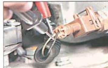
Fig. 1.1. Medida da tensão nominal do sensor ACT.
