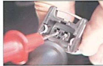
Fig. 4.2. Exemplo de verificação de curto-circuito no chicote do eletroinjeter 1.
