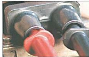
Fig. 3.2. Medida da resistência entre os bornes de alta tensão da bobina de ignição A.
