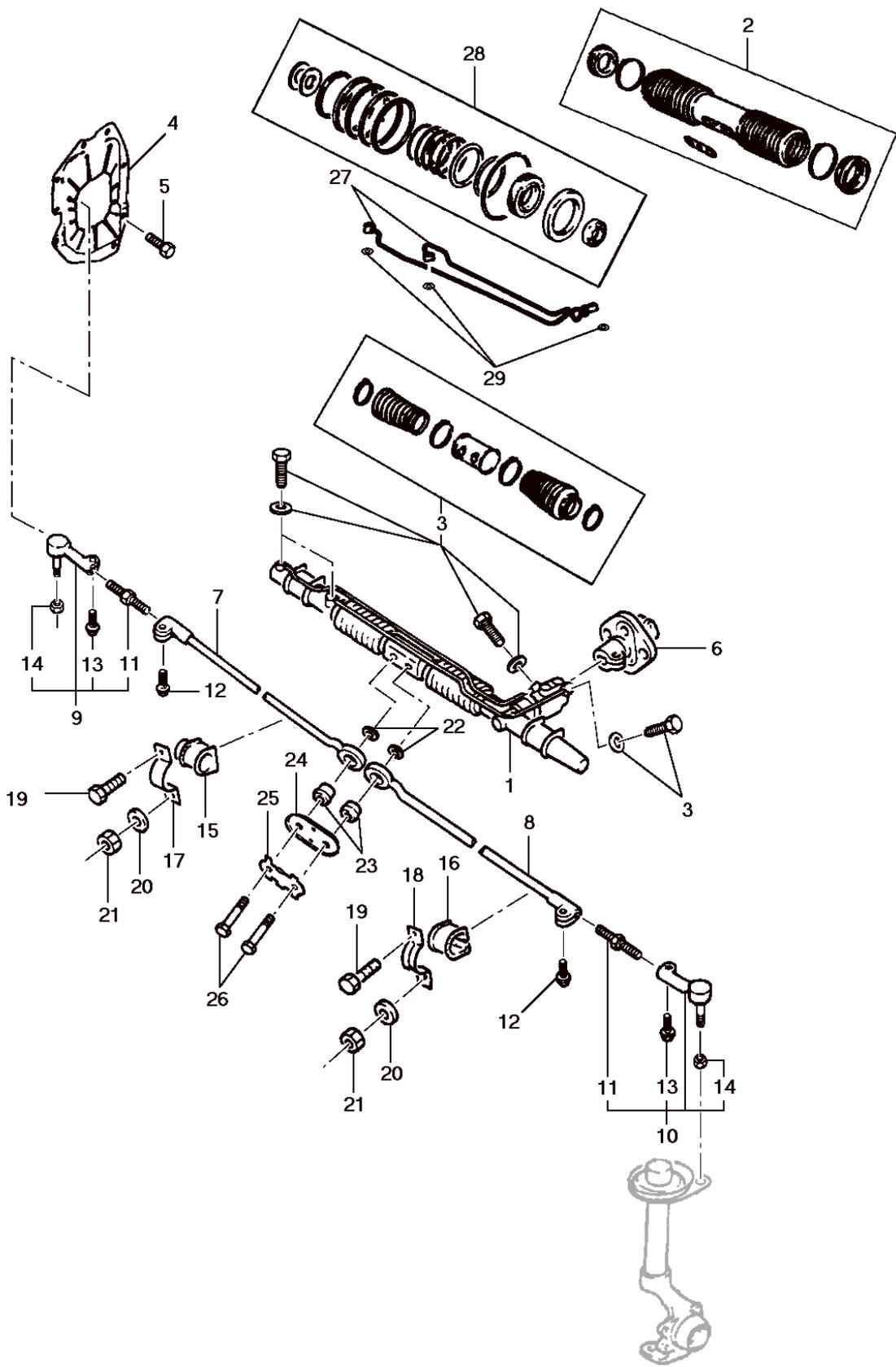
**General Motors do Brasil Ltda.****Veículo:** Vectra 94/96**Assunto:** Caixa e barra de direção**Catálogo Eletrônico de Peças****Edição:** Agosto 2006**Data de Impressão:** 07/05/2020
