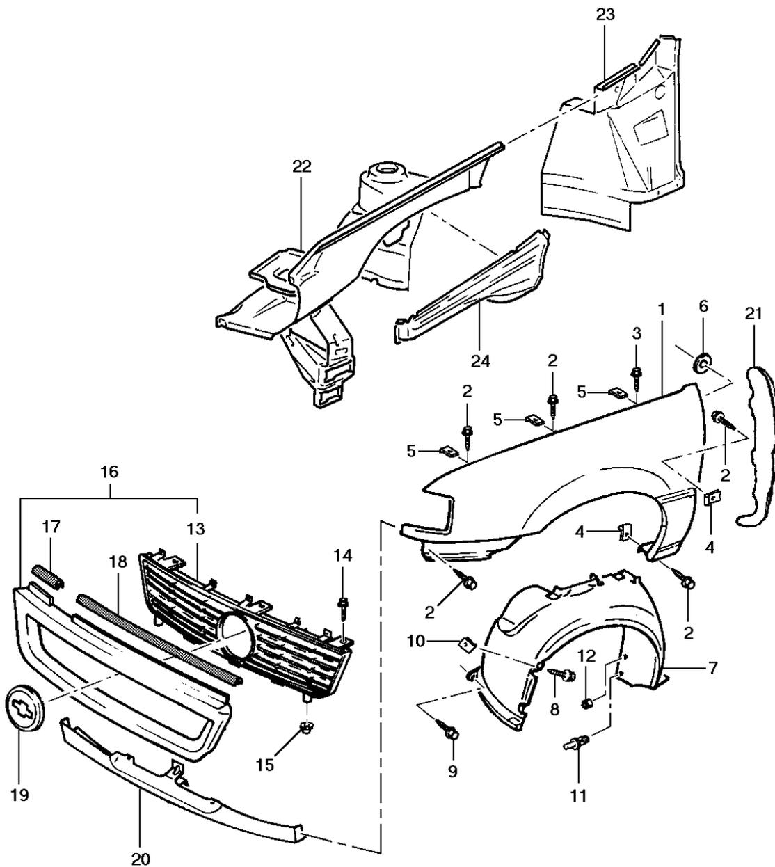
**General Motors do Brasil Ltda.****Veículo:** Vectra 94/96**Assunto:** Caixa de roda, pára-lama e grade do radiador**Catálogo Eletrônico de Peças****Edição:** Agosto 2006**Data de Impressão:** 07/05/2020
