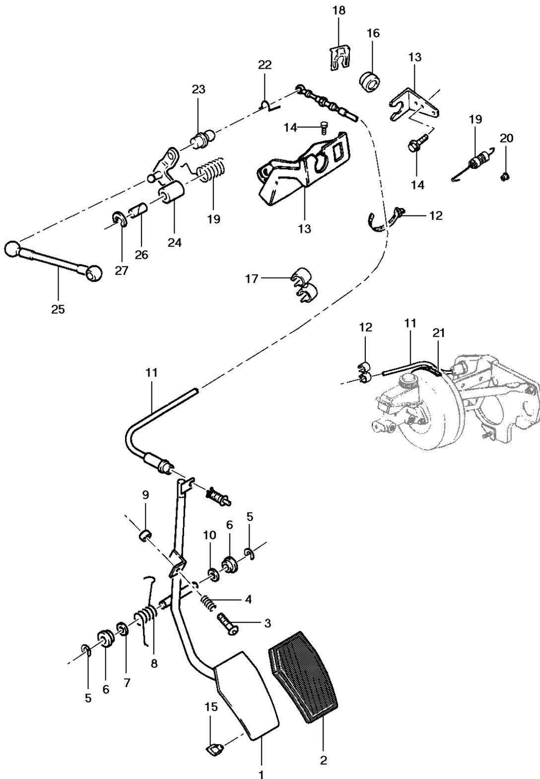
**General Motors do Brasil Ltda.****Veículo:** Vectra 94/96**Assunto:** Pedal e cabo do acelerador**Catálogo Eletrônico de Peças****Edição:** Agosto 2006**Data de Impressão:** 07/05/2020
