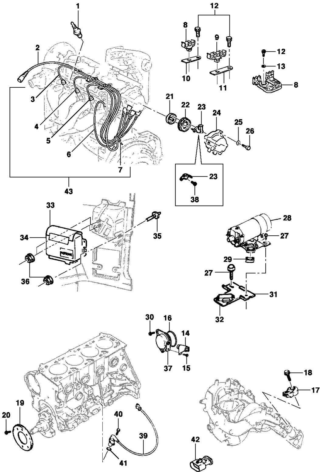
**General Motors do Brasil Ltda.****Catálogo Eletrônico de Peças****Veículo:** Vectra 94/96**Edição:** Agosto 2006**Assunto:** Velas, cabos, módulo, distribuidor, sensores e bobina**Data de Impressão:** 07/05/2020
