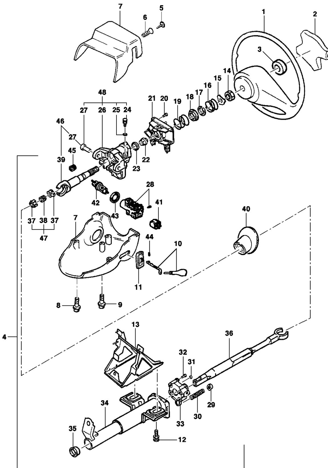
**General Motors do Brasil Ltda.****Veículo:** Vectra 94/96**Assunto:** Volante e coluna regulável da direção**Catálogo Eletrônico de Peças****Edição:** Agosto 2006**Data de Impressão:** 07/05/2020
