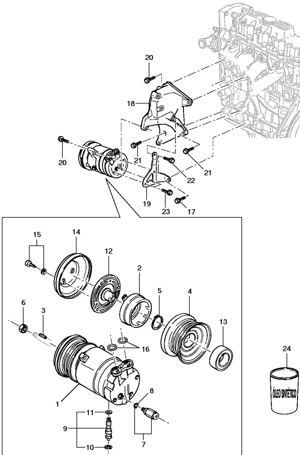
**General Motors do Brasil Ltda.****Veículo:** Vectra 94/96**Assunto:** Compressor do ar condicionado**Catálogo Eletrônico de Peças****Edição:** Agosto 2006**Data de Impressão:** 07/05/2020
