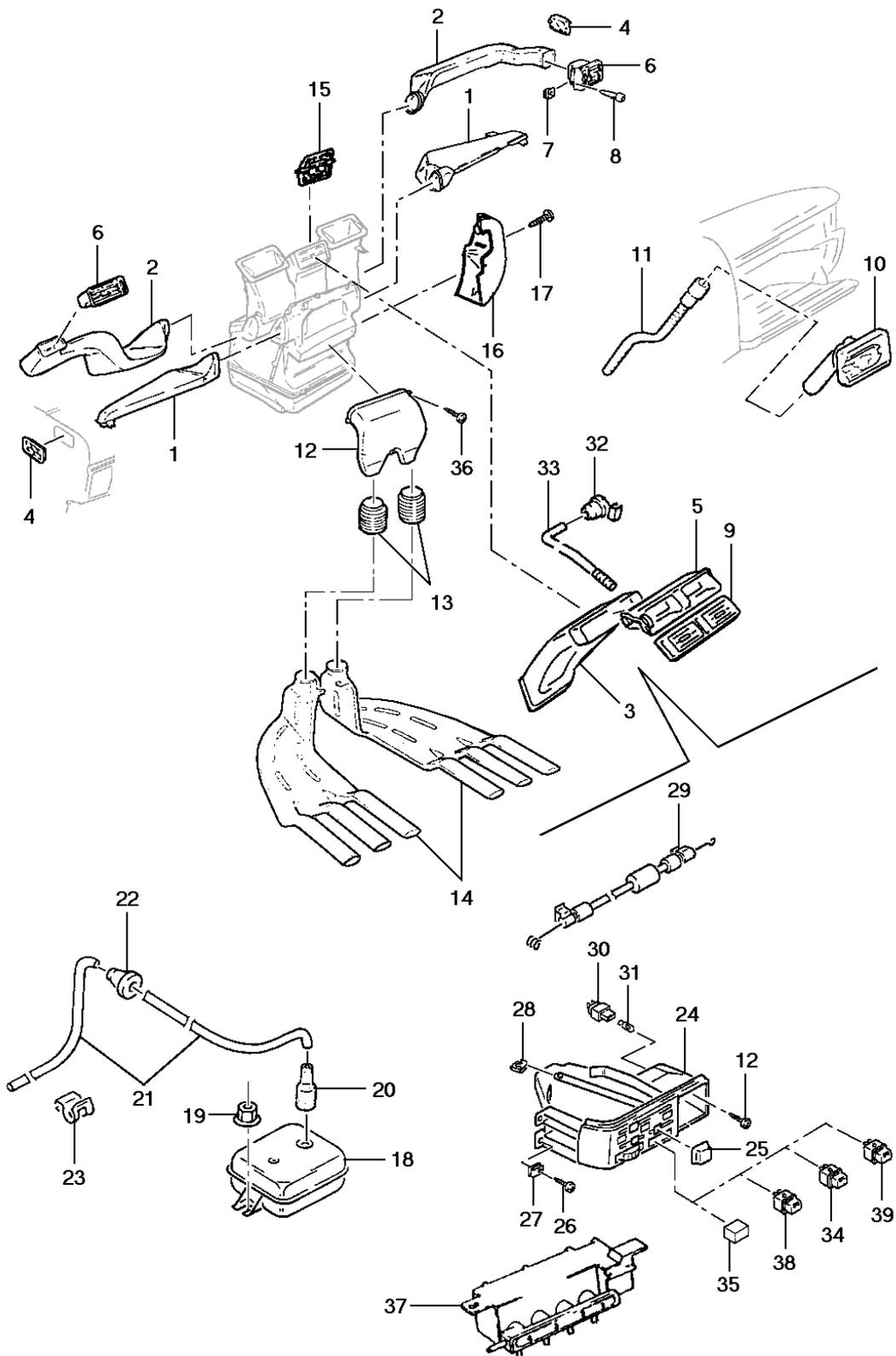
**General Motors do Brasil Ltda.****Catálogo Eletrônico de Peças****Veículo:** Vectra 94/96**Edição:** Agosto 2006**Assunto:** Controle do aquecedor e ar condicionado, dutos e difusores**Data de Impressão:** 07/05/2020
