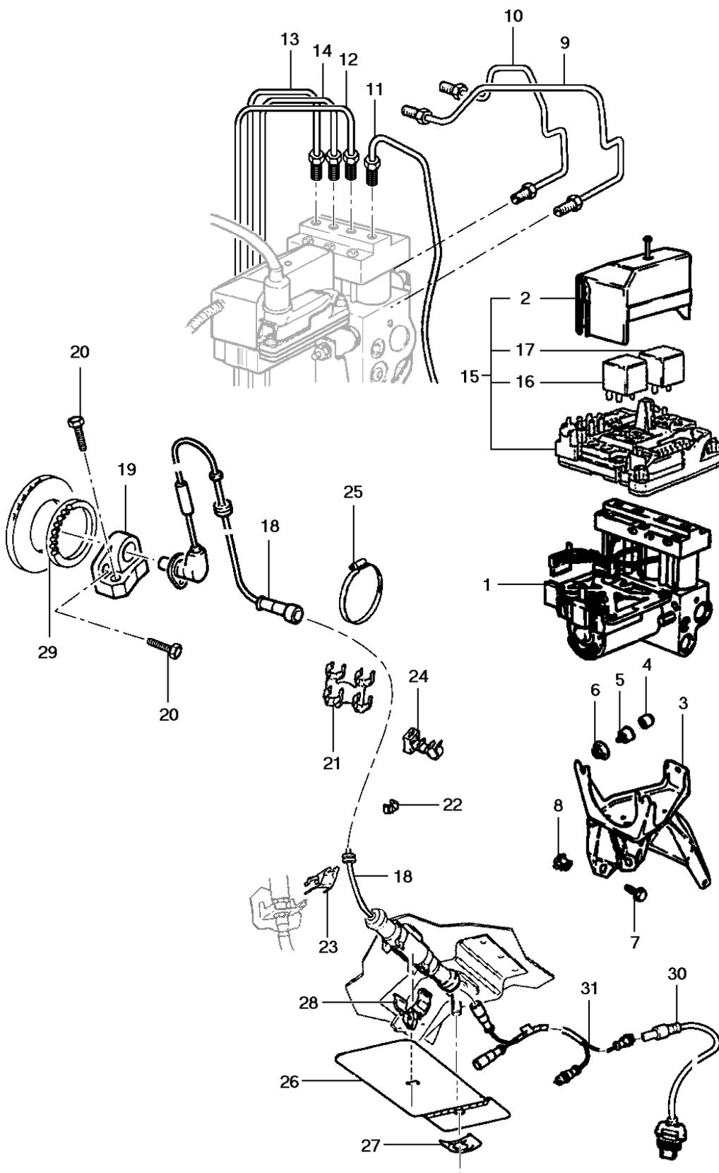
**General Motors do Brasil Ltda.****Veículo:** Vectra 94/96**Assunto:** Sistema ABS**Catálogo Eletrônico de Peças****Edição:** Agosto 2006**Data de Impressão:** 07/05/2020
