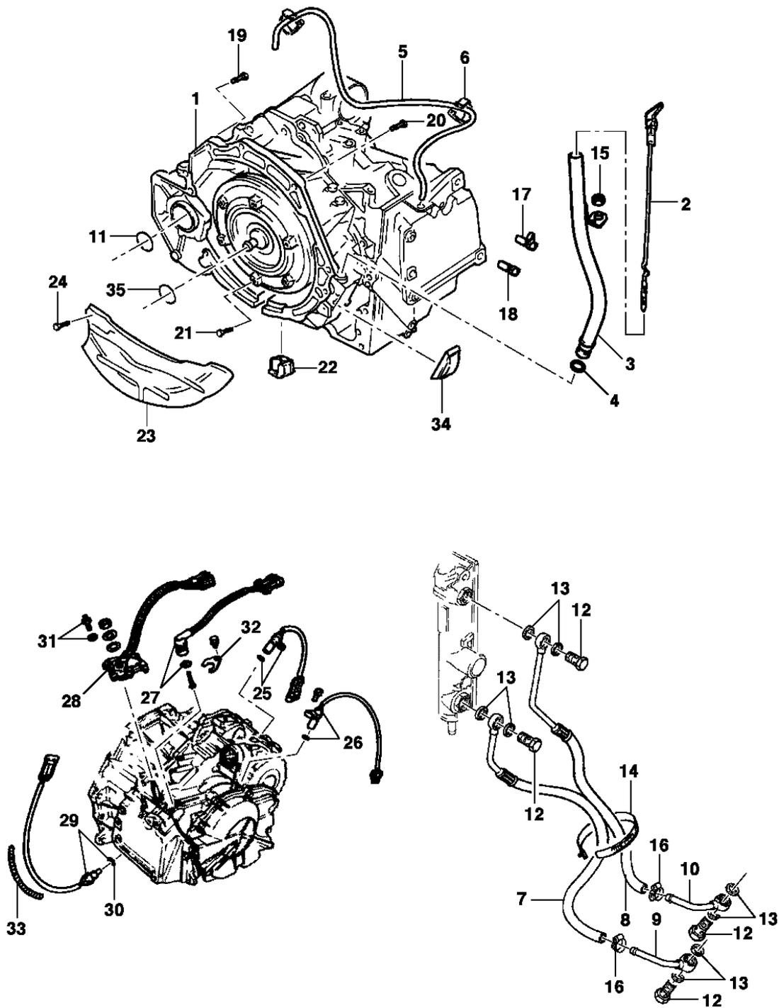
**General Motors do Brasil Ltda.****Veículo:** Vectra 94/96**Assunto:** Transmissão automática, fixação e lubrificação**Catálogo Eletrônico de Peças****Edição:** Agosto 2006**Data de Impressão:** 07/05/2020
