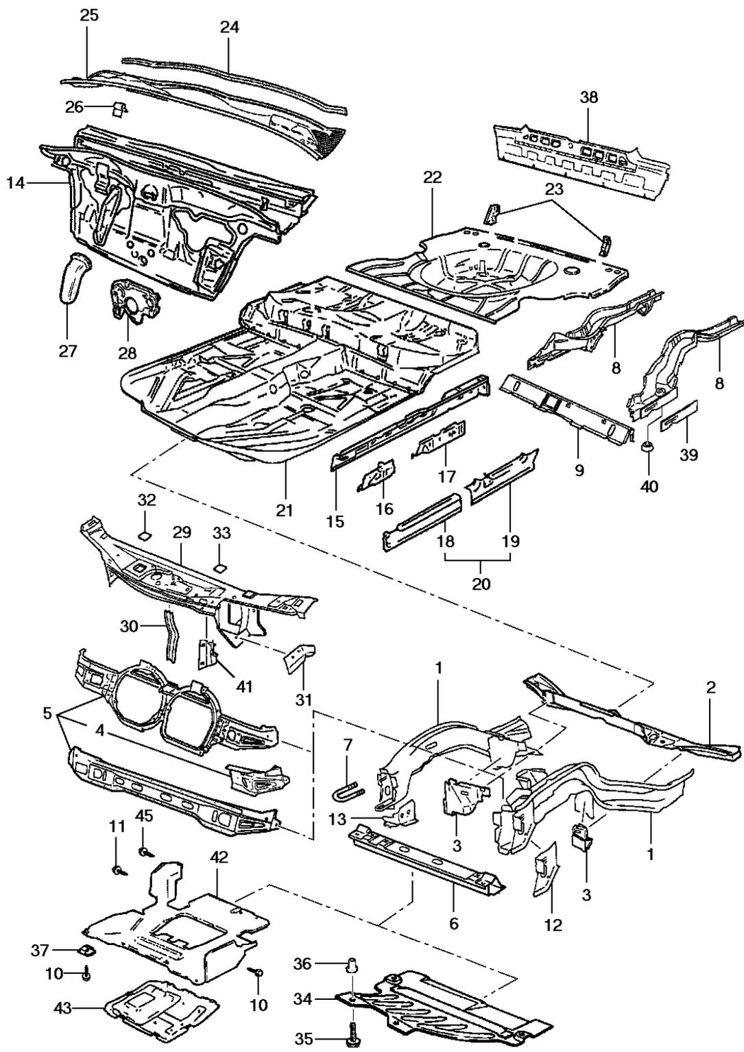
**General Motors do Brasil Ltda.****Catálogo Eletrônico de Peças****Veículo:** Vectra 94/96**Edição:** Agosto 2006**Assunto:** Painel dianteiro, painel dash, painel traseiro e assoalho**Data de Impressão:** 07/05/2020
