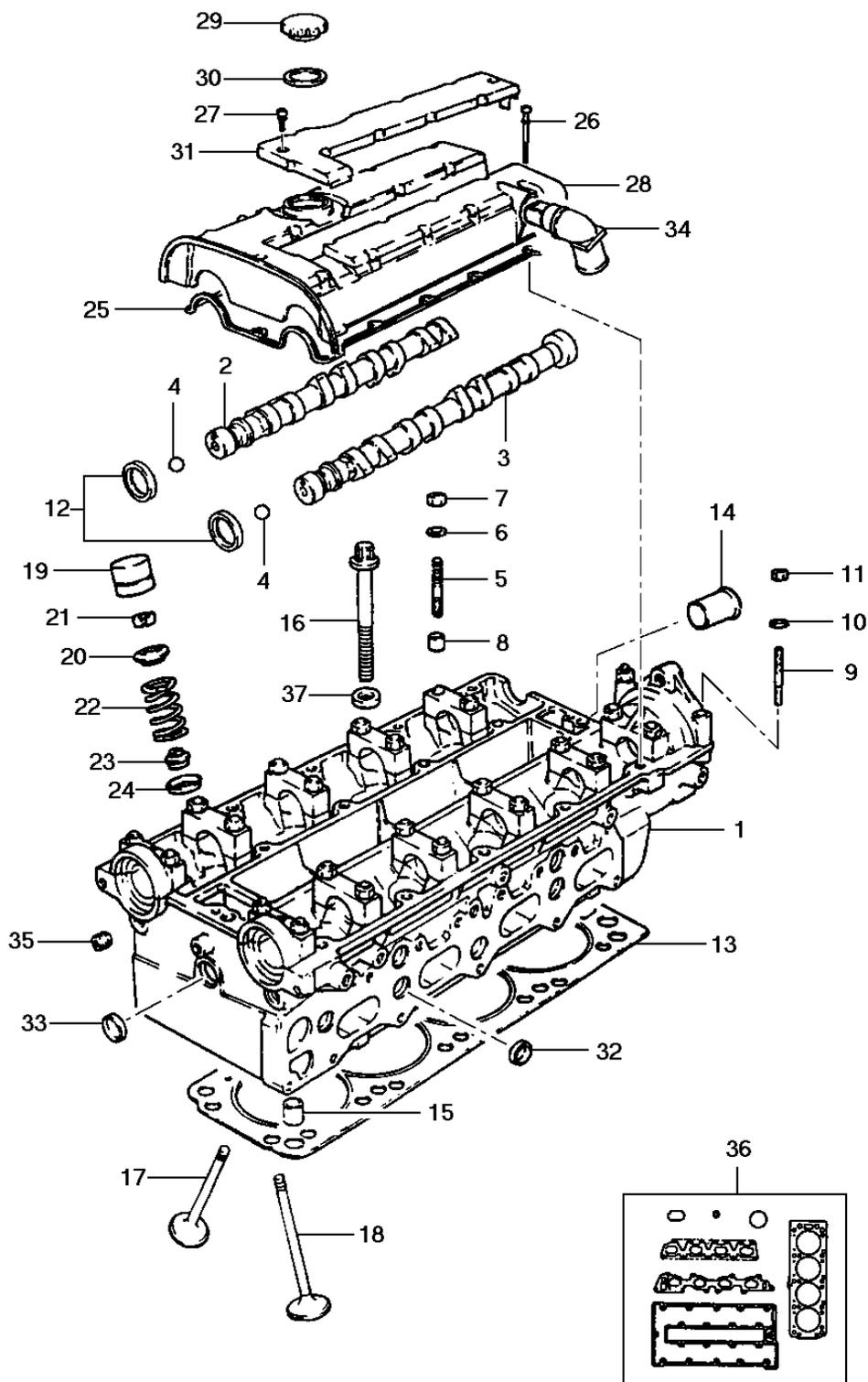
**General Motors do Brasil Ltda.****Veículo:** Vectra 94/96**Assunto:** Cabeçote do motor 16 válvulas**Catálogo Eletrônico de Peças****Edição:** Agosto 2006**Data de Impressão:** 07/05/2020
