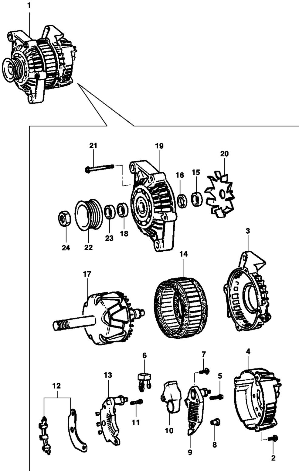
**General Motors do Brasil Ltda.****Veículo:** Vectra 94/96**Assunto:** Alternador 70A - DELCO**Catálogo Eletrônico de Peças****Edição:** Agosto 2006**Data de Impressão:** 07/05/2020
