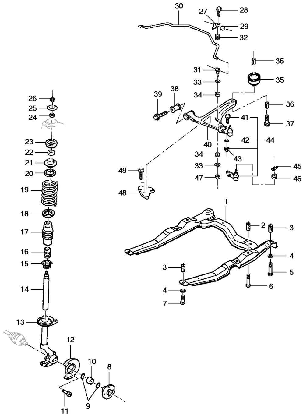
**General Motors do Brasil Ltda.****Veículo:** Vectra 94/96**Assunto:** Suspensão dianteira**Catálogo Eletrônico de Peças****Edição:** Agosto 2006**Data de Impressão:** 07/05/2020
