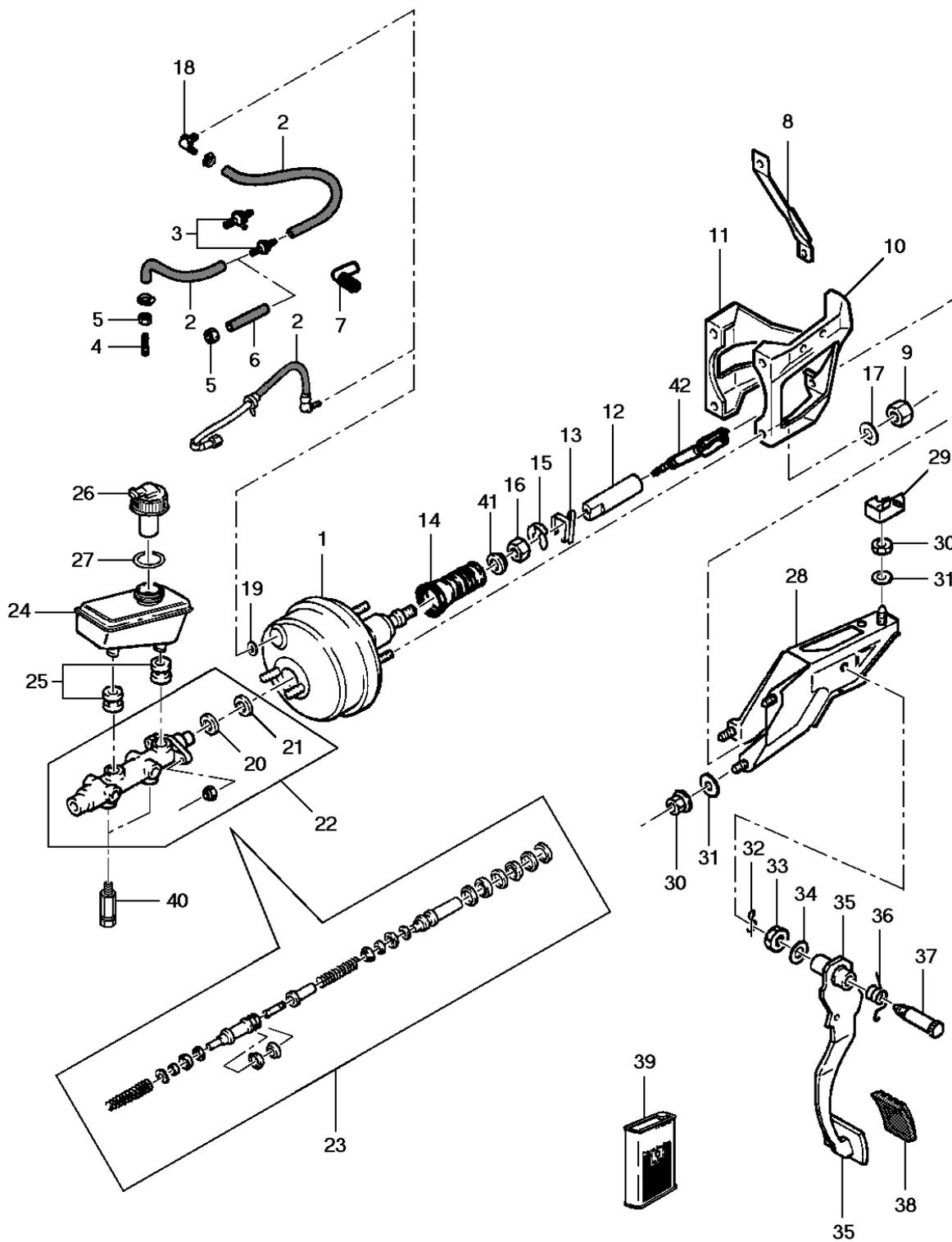
**General Motors do Brasil Ltda.****Veículo:** Vectra 94/96**Assunto:** Pedal de freio, cilindro-mestre e servo-freio**Catálogo Eletrônico de Peças****Edição:** Agosto 2006**Data de Impressão:** 07/05/2020
