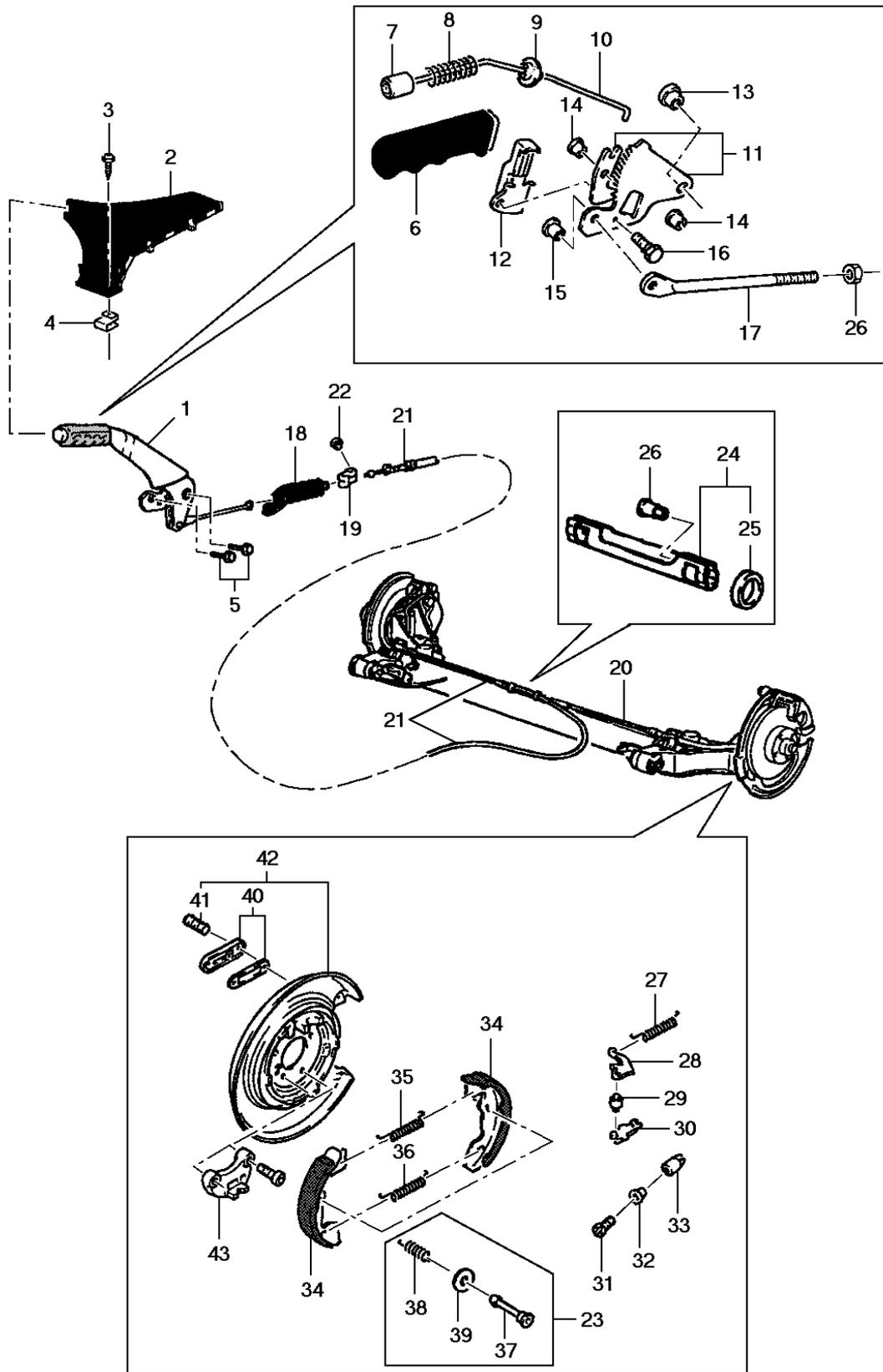
**General Motors do Brasil Ltda.****Veículo:** Vectra 94/96**Assunto:** Freio de estacionamento**Catálogo Eletrônico de Peças****Edição:** Agosto 2006**Data de Impressão:** 07/05/2020
