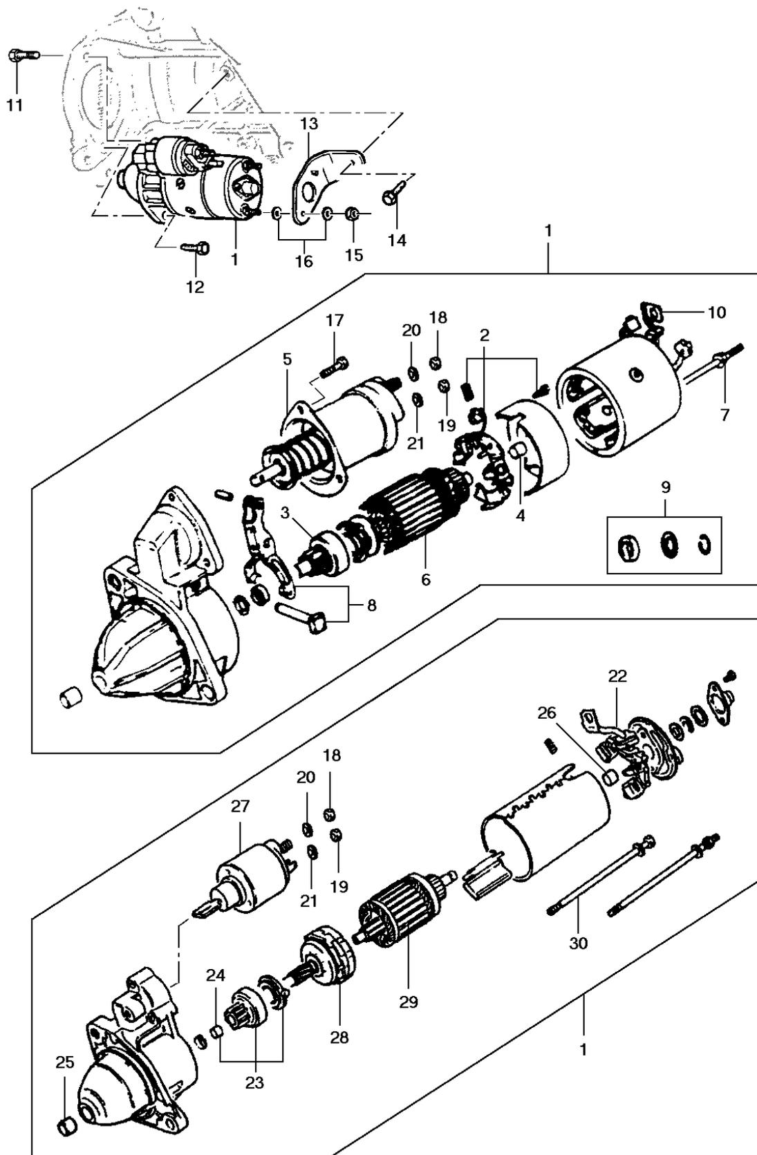
**General Motors do Brasil Ltda.****Veículo:** Vectra 94/96**Assunto:** Motor de partida e fixação - delco e bosch**Catálogo Eletrônico de Peças****Edição:** Agosto 2006**Data de Impressão:** 07/05/2020
