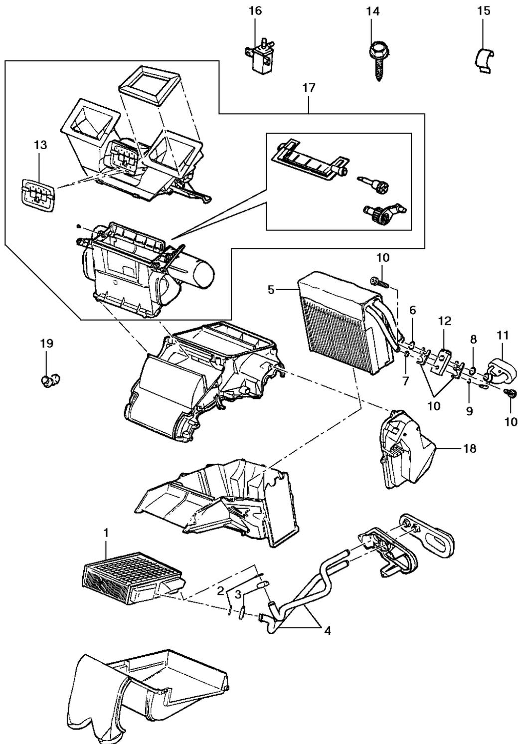
**General Motors do Brasil Ltda.****Veículo:** Vectra 94/96**Assunto:** Câmara do evaporador do ar condicionado R134a**Catálogo Eletrônico de Peças****Edição:** Agosto 2006**Data de Impressão:** 07/05/2020
