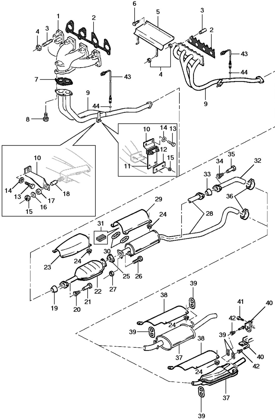
**General Motors do Brasil Ltda.****Veículo:** Vectra 94/96**Assunto:** Sistema de escapamento**Catálogo Eletrônico de Peças****Edição:** Agosto 2006**Data de Impressão:** 07/05/2020
