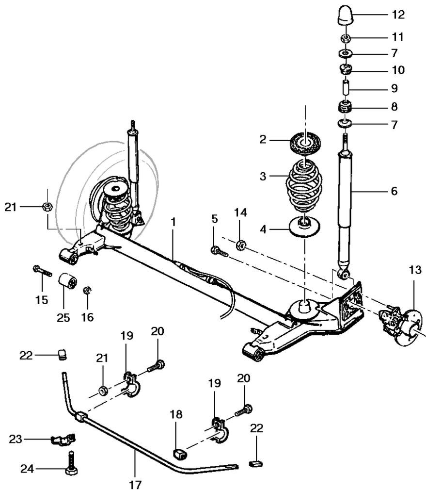
**General Motors do Brasil Ltda.****Veículo:** Vectra 94/96**Assunto:** Barra estabilizadora, mola e amortecedor traseiro**Catálogo Eletrônico de Peças****Edição:** Agosto 2006**Data de Impressão:** 07/05/2020
