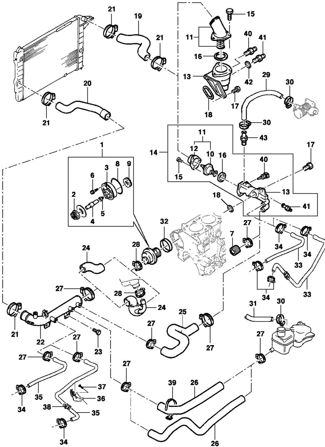
**General Motors do Brasil Ltda.****Catálogo Eletrônico de Peças****Veículo:** Vectra 94/96**Edição:** Agosto 2006**Assunto:** Bomba de água, termostato e sistema de arrefecimento**Data de Impressão:** 07/05/2020
