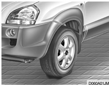
O procedimento que se descreve nas próximas páginas, pode utilizar-se tanto para trocar as rodas, como para mudá-las quando estão furadas. Quando se preparar para mudar uma roda furada, verifique se a alavanca das mudanças está em "P" (aut) ou marcha atrás (mecânica) e o travão de mão accionado, então:
