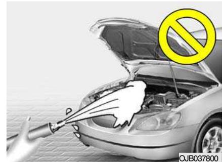
o **As lavagens com água no interior do compartimento do motor incluindo as lavagens com água a alta pressão podem provocar a avaria dos circuitos eléctricos situados no compartimento do motor.**
