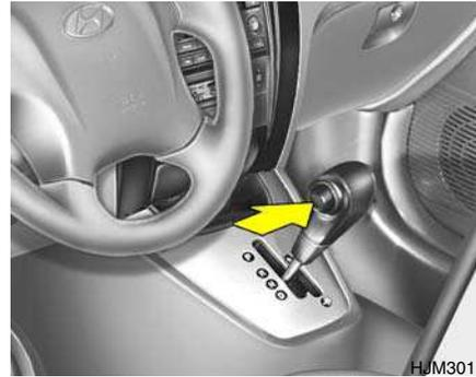
A caixa de velocidades Hyundai de alta eficiência possui quatro relações para a frente e uma para trás. As velocidades individuais são seleccionadas automaticamente, dependendo da posição da alavanca selectora.
