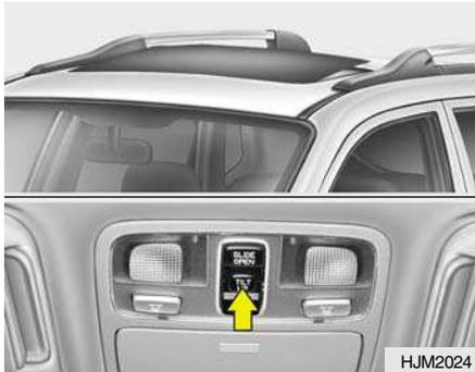
Se o seu veículo tiver este equipamento, pode deslizar ou inclinar o tecto de abrir utilizando os botões de controlo localizados na consola de tecto.
