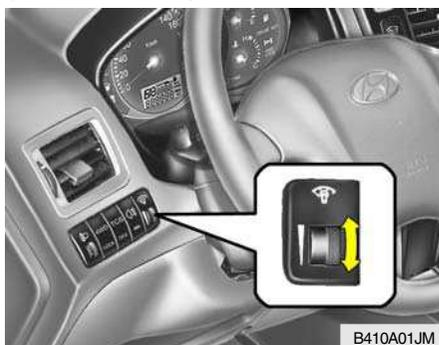
A intensidade da luz do painel de instrumentos pode ser regulada, rodando o botão de controlo da luz do painel de instrumentos.
