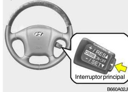
O sistema de controlo da velocidade permite-lhe controlar automaticamente a velocidade do veículo ao circular em auto-estradas ou vias rápidas com pouco trânsito. Este sistema foi concebido para funcionar a velocidades acima de cerca de 40 km/h.
