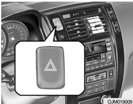
O sistema de emergência de 4 luzes intermitentes, pode ser usado sempre que o achar necessário ou quando parar o carro numa situação perigosa. Se tiver uma dessas paragens de emergência, saia da faixa de rodagem o mais rápido possível.
