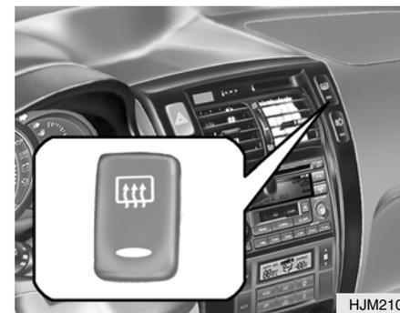
O desembaçador do óculo liga-se, accionando o interruptor. Para desligar o desembaçador, accione o interruptor uma segunda vez. O desembaçador do óculo desliga-se automaticamente, passados cerca de 15 minutos. Para recomeçar o ciclo do desembaçador, accione o interruptor do desembaçador novamente depois deste se ter desligado.
