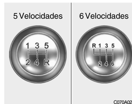
O seu HYUNDAI está equipado com uma caixa de velocidades do tipo convencional, cujo esquema se encontra representado na figura e impresso no topo da alavanca das mudanças. É do tipo sincronizado, tanto para mudanças altas, como para mudanças baixas, o que facilita as operações.
