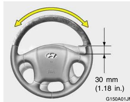
Para verificar a folga do volante, páre o carro com as rodas colocadas a direito, e mova ligeiramente o volante para um lado e para o outro. Utilize uma leve pressão dos dedos e seja sensível às variações na resistência oferecida nos limites do movimento.
