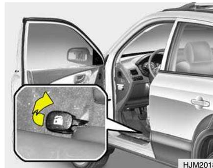
A tampa do depósito de combustível pode ser aberta do interior do veículo, puxando a alavanca de comando da tampa de combustível que se encontra situada no chão, do lado esquerdo do banco do condutor.
