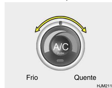
O comando de temperatura é usado para ligar e desligar o aquecimento e seleccionar o grau de aquecimento desejado.
