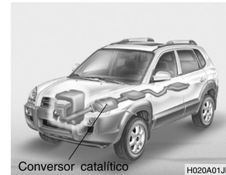
Os veículos Hyundai estão equipados com um catalisador de três vias, do tipo monólito, para a redução do teor em monóxido de carbono, hidrocarbonetos e óxidos de azoto, que fazem parte da composição dos gases de escape.
