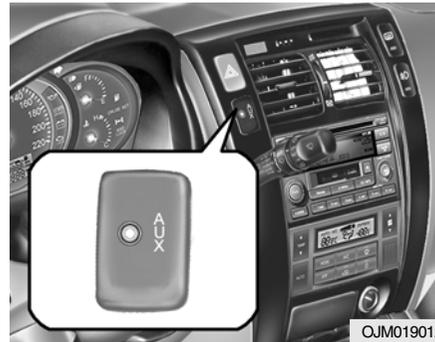
Pode utilizar uma saída aux (auxiliar) para ligar um dispositivo de áudio.
