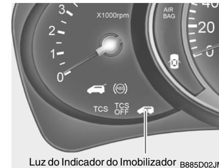
No caso do sistema immobilizer estar avariado, não será possível colocar o motor em funcionamento sem o procedimento em caso de avaria utilizando a chave de ignição.
