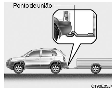
5. Vão máximo permitido no ponto de engate : 910 mm.
