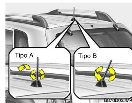
A recepção de emissões AM e FM é feita através de uma antena colocada no tejadilho do veículo.
