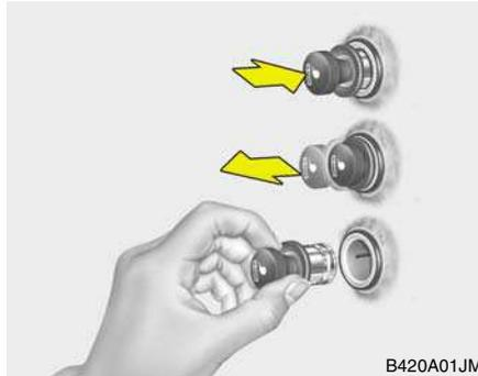
Para o isqueiro funcionar, a chave da ignição tem de estar nas posições "ACC" ou "ON". Para acender o isqueiro, empurre-o até prender. Quando o elemento estiver quente, o isqueiro sairá automaticamente para a posição de pronto. Não force o isqueiro para o manter na posição de aquecimento. Isso pode danificar o elemento e provocar fogo. Se for necessário substituir o isqueiro, use somente um substituto HYUNDAI genuíno.
