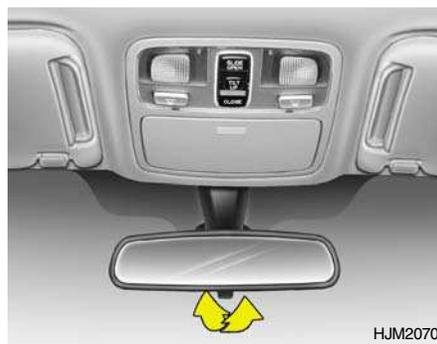
O seu HYUNDAI está equipado com um retrovisor diurno-nocturno. A posição nocturna é seleccionada, puxando a patilha na parte inferior do retrovisor para si. Na posição nocturna, a luz dos veículos que o seguem é reduzida.
