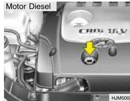
Antes de verificar o nível de óleo, aqueça o motor até a uma temperatura normal de funcionamento e certifique-se que está parado em solo nivelado. Desligue o motor.
