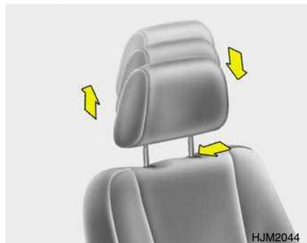
Os apoios de cabeça estão desenhados para ajudar a reduzir o risco de lesões ao nível do pescoço. Para elevar o apoio de cabeça, puxá-lo para cima. Para o descer, empurrá-lo para baixo enquanto prime o botão de bloqueio. Para retirar o encosto da cabeça levante-o o mais possível e, em seguida, prima o botão de travamento ao mesmo tempo que puxa o encosto para cima.
