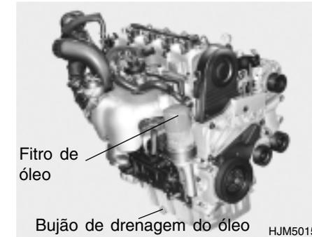
1. Estacione o automóvel num lugar nivelado e active o travão de mão. Ponha o motor a trabalhar até que alcance a temperatura normal de funcionamento. Pare o motor e coloque a alavanca em "PARK" (caixa automática) ou em marcha atrás (caixa manual).
