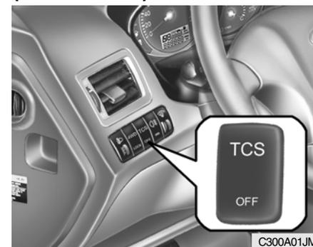
Em estradas com superfícies escorregadias, o sistema de controlo da tracção (TCS) impede que as rodas de tracção patinem excessivamente, ajudando assim a viatura a acelerar. Também fornece a força necessária de tracção e melhora a performance da direcção quando efectua curvas em aceleração.
