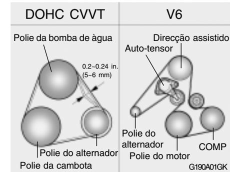
As correias devem ser verificadas periodicamente, para um adequado ajuste da tensão. Da mesma maneira, deverão ser verificadas se têm cortes, gastos, pontos desfiados, ou outros danos, substituindo-as, se necessário. O sector por onde passam as correias deve ser revisto para que não haja nenhuma interferência.
