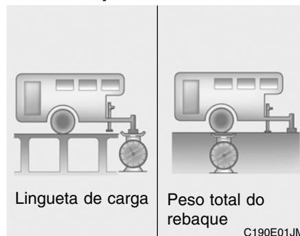
O peso nas linguetas pode ser aumentado ou diminuído redistribuindo o peso da carga no reboque. Para isso verifique o peso total da carga no reboque e o peso absorvido pela lingueta.
