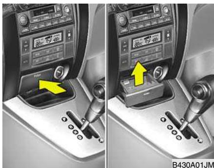
O cinzeiro dianteiro pode ser aberto premindo e libertando, em seguida, a tampa do cinzeiro. Para retirar o cinzeiro para esvaziar ou limpar, levante o cinzeiro para cima e puxe para fora. A luz do cinzeiro só iluminará quando as luzes exteriores do veículo estiverem acesas (Se instalado).
