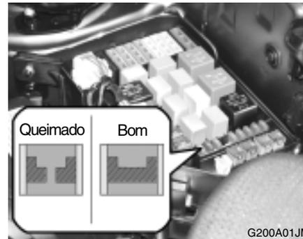
Um fusível pode derreter devido a uma sobrecarga eléctrica. Isto provém de um circuito eléctrico que se queima. (Pode ser provocado por uma passagem excessiva de corrente). Se isto acontecer muitas vezes, deverá ser visto pelo Serviço de Assistência HYUNDAI para determinar a causa da anomalia, reparar o sistema e substituir o fusível. Os fusíveis principais, estão localizados junto à bateria, de muito fácil acesso para inspecção.
