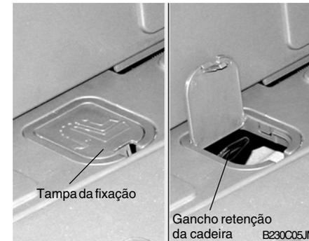
1. Abra a tampa dos pontos de ancoragem com alça de fixação existente no chão do porta-bagagens.
