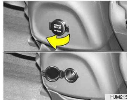
Estas tomadas estão instaladas na moldura do painel e na consola traseira. Fornecem corrente de 12 V e permitem ligar acessórios ou equipamento eléctrico, mas apenas quando a chave se encontra na posição "ON" ou "ACC".
