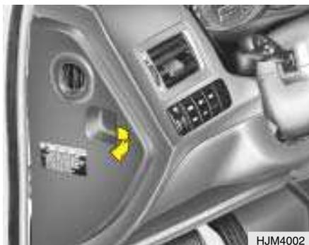
A caixa dos fusíveis para os circuitos das lâmpadas e outros acessórios eléctricos está localizada do lado esquerdo, por baixo do tablier. Dentro da caixa poderá encontrar uma lista que indica quais os circuitos protegidos por cada fusível.
