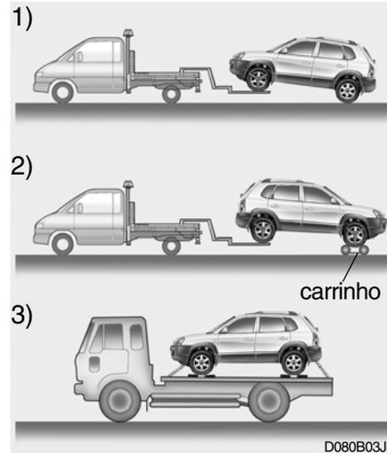
O seu veículo pode ser rebocado com um sistema de elevação das rodas (1), (2) ou sobre uma plataforma (3).
