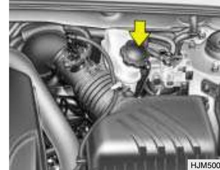
O nível de líquido de embraiagem na bomba principal, deverá ser verificado sempre que se faz revisão do compartimento do motor. Para além disso, ao mesmo tempo deverá verificar cuidadosamente se o nível do líquido se encontra entre as marcas "MAX" e "MIN".
