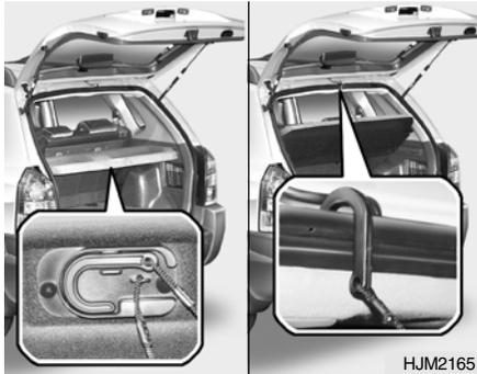
Antes de utilizar o tabuleiro por baixo da bagagem, prenda o gancho da tampa de cobertura da área de carga à tira fixação. Quando não estiver a utilizar, coloque novamente o gancho da tampa de cobertura da área de carga na posição inicial.
