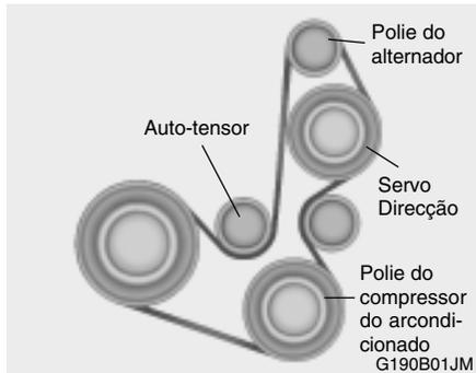
Nas inspecções regulares de manutenção, as correias devem ser verificadas para ver se apresentam fendas, desgaste, rasgos ou sinais de deterioração, sendo substituídas, se necessário.
