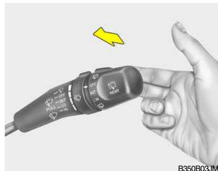
Para usar o esguicho do pára-brisas, puxe a alavanca do limpa pára-brisas para o volante. Os limpa pára-brisas farão automaticamente dois compassos de limpeza do pára-brisas. O esguicho do pára-brisas continuará a funcionar enquanto não soltar a alavanca.
