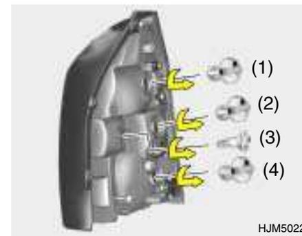
4. Para substituir as lâmpadas do farol traseiro combinado (Travão/ Mínimos, Indicador de Mudança de Direcção ou Farol de Marcha-Atrás), tire-a do respectivo suporte rodando-a no sentido contrário ao dos ponteiros do relógio.
