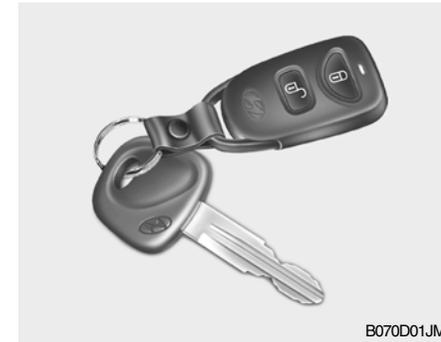
O sistema é desarmado quando a porta do condutor ou a porta do passageiro da frente for destrancada premindo o botão "UNLOCK" existente no transmissor.
