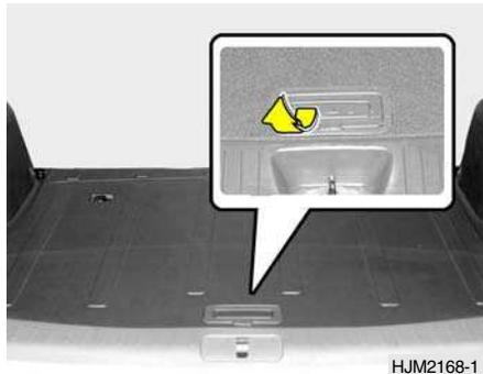
Levante a tampa do tabuleiro por baixo da bagagem utilizando a pega.
