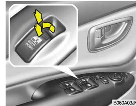
Os vidros eléctricos só funcionam quando a chave da ignição está na posição "ON". Os interruptores principais estão situados no apoio para o cotovelo do condutor e controlam os vidros dianteiros e traseiros de ambos os lados do veículo.
