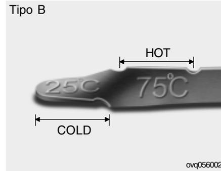
3. Certifique-se de que o nível do fluido está no intervalo com a indicação "75°C" no indicador de nível. Se o nível do fluido estiver abaixo desta indicação, adicione o fluido especificado através do orifício de enchimento. Se o nível do fluido estiver acima desta indicação, drene o fluido em excesso através do orifício de drenagem.
