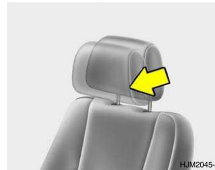
O encosto para a cabeça pode ser inclinado para a frente e colocado em três posições diferentes, bastando para isso puxá-lo para a frente. Para inclinar para trás o encosto para a cabeça, puxe-o totalmente para a frente e liberte-o em seguida. Ajuste o encosto para a cabeça de modo a que apoie adequadamente a cabeça e o pescoço.
