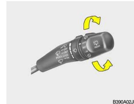
1. : O limpa-vidros traseiro faz três movimentos de limpeza quando é pulverizado o líquido de lavagem no vidro traseiro.
