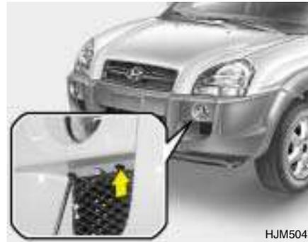
1. Remova a tampa utilizando uma chave de parafusos Philips (+).
