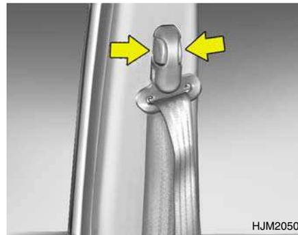
É possível ajustar a altura do ponto de fixação do cinto numa das 4 posições. Se o cinto ficar muito perto do pescoço do utilizador, a protecção não é adequada. O segmento superior do cinto deverá ficar a meio do ombro e mais perto da porta do que do pescoço. Para alterar a altura do ponto de fixação do cinto, desloque o ajustador para cima e para baixo até encontrar a posição adequada. Para levantar basta puxar para cima. Para baixar, carregar no botão e puxar para baixo.
