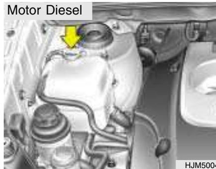
O nível de refrigerante pode ser visto dentro do reservatório de plástico. O nível deverá estar entre as linhas "L" e "F" do reservatório. Se o nível está abaixo da marca "L", junte refrigerante de modo a que o nível suba entre "L" e "F". Se o nível fôr mais baixo, procure fugas de refrigerante e verifique o nível frequentemente. Se o nível cair de novo, visite o Serviço de Assistência HYUNDAI para uma inspeção e diagnóstico da causa.
