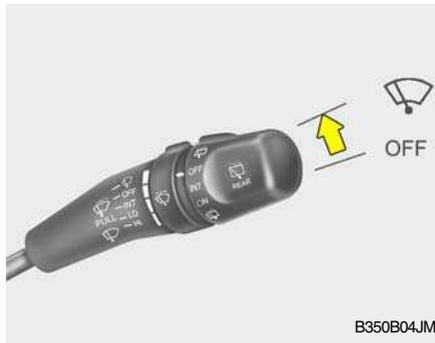
Se pretender apenas um varrimento do limpa vidros, empurrar a alavanca de comando do limpa vidros para cima.
