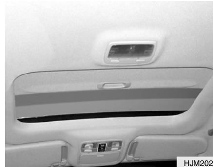
O seu HYUNDAI está equipado com um sombreador deslizante que pode ser ajustado manualmente para deixar entrar a luz do sol com o tecto de abrir fechado, ou para bloquear a luz do sol.
