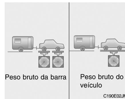
2. O peso bruto total do veículo com o atrelado não deve exceder a repartição do peso bruto do veículo (GVWR) indicado na placa de identificação do veículo (ver pág. 8-2). O peso bruto total carga, gancho, lingueta de carga e outro equipamento opcional.
