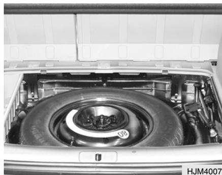
Remova o pneu sobressalente e o saco com as ferramentas do interior da bagageira.
