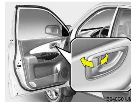
As portas podem ser bloqueadas pelo exterior. Primeiro, pressione o botão de bloqueio para a posição "LOCK", de forma a que a marca vermelha no botão de bloqueio não seja visível, depois feche a porta.
