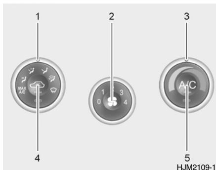
Este modelo tem três comandos para o sistema de aquecimento e arrefecimento;
