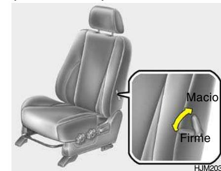
O banco do condutor, num Hyundai está equipado com um suporte lombar ajustável. Para aumentar o apoio lombar, puxe a alavanca para a frente e para diminuí-lo empurre a alavanca para trás.
