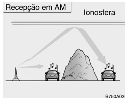
A recepção dos sinais de AM é, normalmente, melhor do que em FM. Isto deve-se ao facto das ondas de AM serem transmitidas em baixas frequencias. Estas ondas longas, de baixa frecuencia podem seguir a curvatura da Terra, em vez de seguirem a direito para a atmosfera. Além disso, dão a volta aos obstáculos, assegurando assim uma cobertura mais perfeita.
