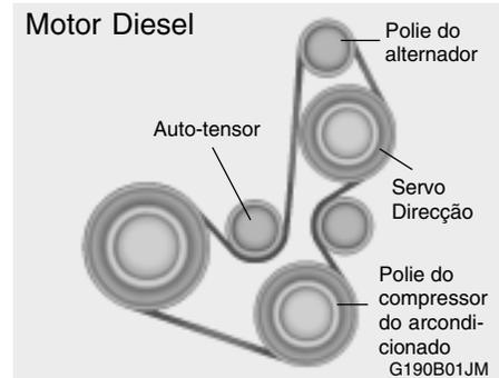
Quando o ar condicionado é usado com regularidade, a tensão da correia do compressor deve ser verificada, pelo menos, uma vez por mês. Para verificar a tensão da correia, carregar na mesma a meia distância entre as polies da cambota e do compressor. Ao pressionar com os seus dedos a correia não a deve flectir mais do que 8,0 mm.
