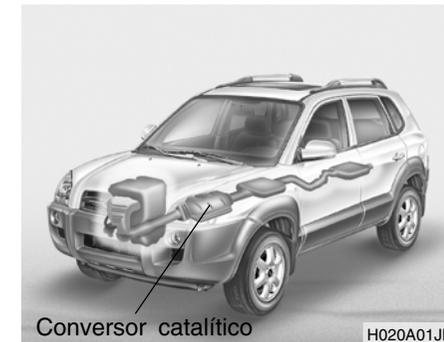
O catalizador, peça parecida com a panela de escape e colocada por debaixo do veículo no sistema de escape, serve para retirar alguns dos gases contidos na emissão resultante da combustão no interior do motor.
