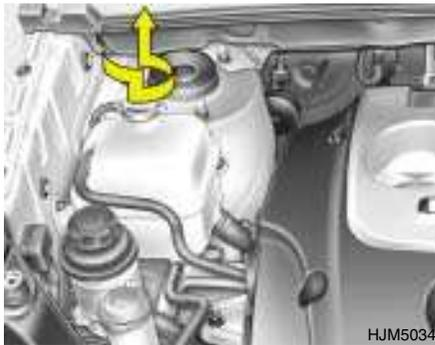
4. Girar a tampa do radiador para a esquerda sem o pressionar para baixo até parar. Desta forma alivia-se qualquer pressão ainda existente no sistema de refrigeração. Para remover a tampa do radiador, pressionar e girar para a esquerda. Encher o radiador com água limpa desmineralizada ou destilada em pequenas quantidades até atingir o nível do gargalo do radiador.
