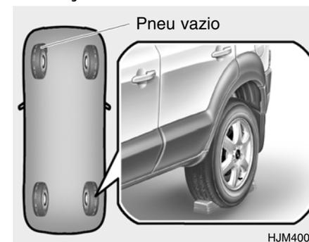
Calçe a roda diagonalmente oposta à furada, para evitar que o veículo se mova quando fôr levantado pelo macaco.
