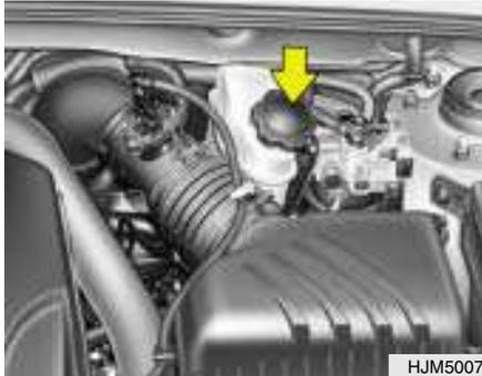
O nível de óleo de travões deverá ser verificado periodicamente. O nível deverá estar entre as marcas "MIN" e "MAX" inscrita de lado no reservatório. Se o nível estiver no "MIN" ou abaixo dessa marca, ateste cuidadosamente até atingir a marca "MAX". Não encha demasiado.
