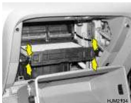
3. Remova a tampa do filtro do ar condicionado premindo os grampos de ambos os lados.
