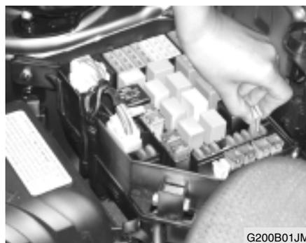
4. Substitua o fusível queimado, colocando com leve pressão um novo, com a mesma amperagem no lugar do anterior.
