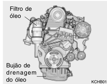
O filtro e o óleo do motor deverão ser mudados periodicamente, com intervalos indicados no programa de manutenção, indicados na secção 5. Se o óleo começar a ser utilizado em condições de tráfego severas, aconselha-se a reduzir os intervalos de tempo entre cada mudança.
