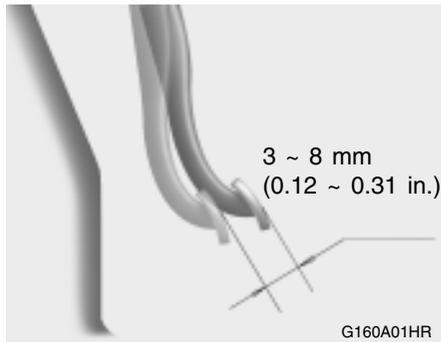
Com o motor parado, pressione várias vezes para reduzir o efeito do vácuo no servo-freio.
