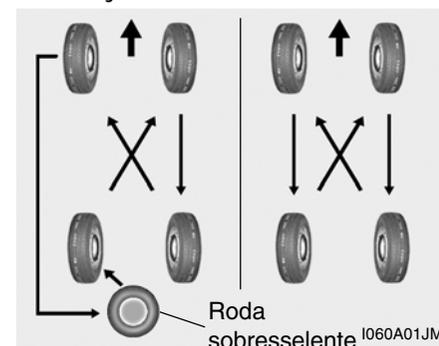
Os pneus deverão ser trocados cada 10.000 Km (6.000 milhas). Se verificar que os pneus estão a ficar desigualmente gastos entre cada troca de pneus, leve o seu carro ao Serviço de Assistência HYUNDAI para que a causa possa ser corrigida. Depois de cada troca, ajuste a pressão dos pneus e aperto das rodas.
