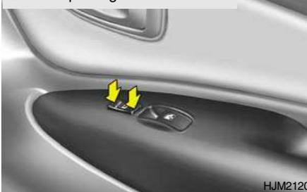
O interruptor do fecho centralizado das portas está localizado no apoio para o braço do condutor e do passageiro da frente. O fecho centralizado é accionado quando é premido o interruptor do fecho das portas.
