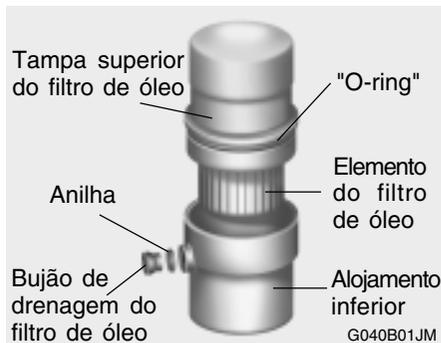
5. Desapertar o bujão do filtro de óleo, rodando-o para a esquerda com uma chave apropriada e drenar parte do óleo. Ter um contentor pronto a receber o óleo drenado.
