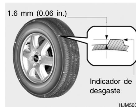
Os pneus originais do seu carro têm indicadores de desgaste. Estes são visíveis quando a profundidade do trilho é de 1,6 mm (0,06 in.). O pneu deve ser substituído quando isto aparece como uma barra sólida atravessando 2 ou mais estrias. Substitua-os sempre por outros com as medidas recomendadas. Se substituir as rodas, as novas jantes devem ser as indicadas pela HYUNDAI.
