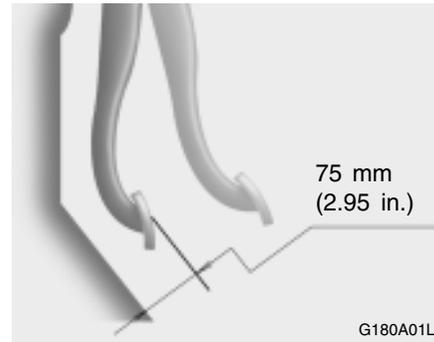
Precisa de um ajudante para medir a folga do pedal dos travões. Com o motor a trabalhar, peça ao seu ajudante para carregar diversas vezes no pedal de travões, e depois para o manter em baixo utilizando uma força de 50 Kg, 490 Nm (110 lbs.). A folga do pedal é a distância entre a parte superior do pedal e o piso sob a alcatifa.
