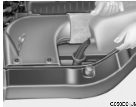
5. Ponha o motor a trabalhar, encha completamente o radiador de água e junte então o refrigerante no reservatório até atingir a marca entre "L" e "F".
