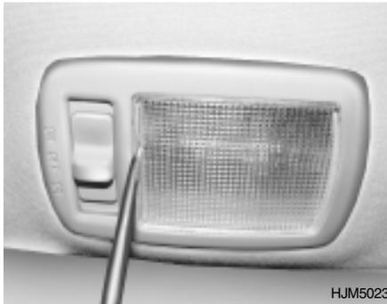
1. Remova a tampa utilizando uma chave de fendas plana (-).
