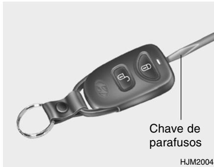
1. Separar a cobertura com uma chave de parafusos, como mostra a ilustração.
