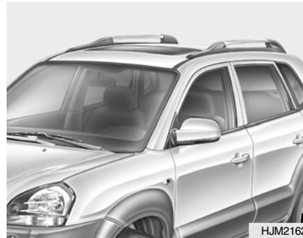
Se o seu Hyundai estiver equipado com grade portabagagens pode colocar carga no topo de veículo.
