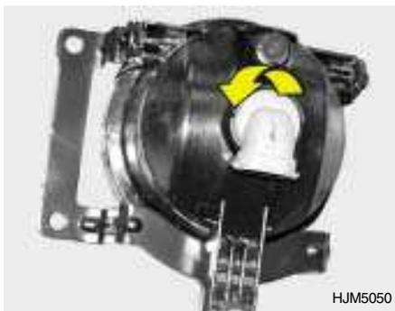
4. Substitua a lâmpada fundida por uma nova.
