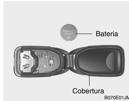
2. Remover a pilha antiga da e verificara sua polaridade. Certificar-se que a polaridade da nova pilha é a mesma (pólo + virado para baixo), depois inserir a pilha no transmissor.
