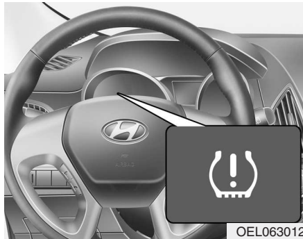
Indicador de baixa pressão dos pneus / Indicador de avaria do sistema TPMS
