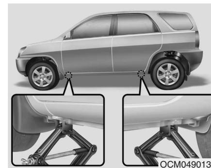
7. Coloque o macaco à frente ou atrás da posição do macaco, o mais perto possível do pneu que pretende trocar. Coloque o macaco nos locais indicados sob o quadro. As posições de colocação do macaco são placas soldadas ao quadro com duas patilhas e um ponto levantado para assentar o macaco.
