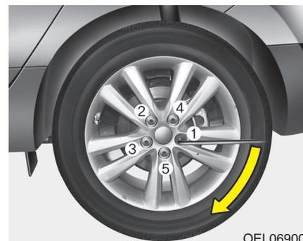
Em seguida, coloque a chave de rodas como se mostra na figura e aperte as porcas da roda. Certifique-se de que a chave de caixa assenta completamente na porca. Não se apoie no manípulo da chave de rodas nem utilize um tubo de extensão sobre o manípulo da chave.
