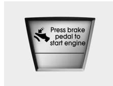
Se o botão ENGINE START/STOP rodar para a posição ACC duas vezes, por pressionar o botão repetidamente sem carregar no pedal do travão, acende-se uma luz avisadora no visor LCD durante 10 segundos para indicar que deve carregar no pedal do travão para ligar o motor de arranque.
