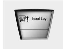
Se pressionar o botão ENGINE START/STOP enquanto surge no visor LCD a mensagem "Chave não detectada", acende-se no visor o aviso "Inserir chave" durante cerca de segundos. Além disso, a luz indicadora do imobilizador de arranque e a luz do suporte da chave piscam durante 10 segundos.
