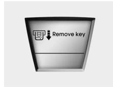
Quando desligar o motor com o dispositivo Smart Key no respectivo suporte, a luz avisadora acende-se no visor LCD
