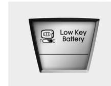
Se o botão ENGINE START/STOP rodar para a posição OFF devido à pilha do dispositivo Smart Key no veículo estar a ficar sem carga, acende-se uma luz avisadora no visor LCD durante 10 segundos e o sinal sonoro soa uma vez. Substitua pilha por uma nova.
