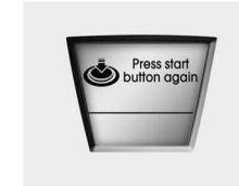
Se não conseguir fazer funcionar o botão ENGINE START/STOP quando ocorre um problema com o respectivo sistema, a luz avisadora acende-se durante 10 segundos e o sinal sonoro faz-se ouvir de forma continua para indicar que pode ligar o motor de arranque pressionando mais uma vez o botão ENGINE START/STOP.
