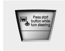
Se ao pressionar o botão ENGINE START/STOP o volante não desbloquear normalmente, a luz avisadora acende-se no visor LCD durante 10 segundos.
