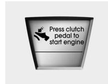
Se o botão para ligar/desligar o motor passar para a posição "ACC" duas vezes por ser pressionado repetidamente sem carregar no pedal da embraiagem, o aviso acende-se no visor LCD durante cerca de 10 segundos para indicar que deve carregar no pedal da embraiagem para ligar o motor.
