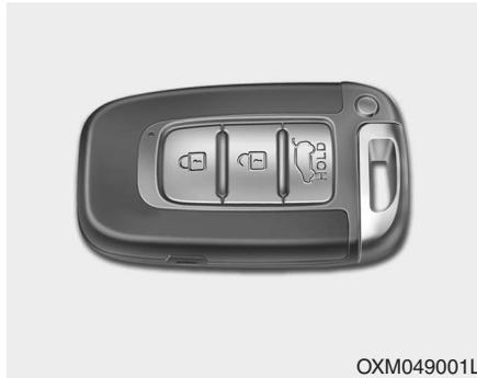
Com o dispositivo Smart Key, pode trancar ou destrancar qualquer porta (incluindo a da mala) e até ligar o motor de arranque sem inserir a chave na fechadura.
