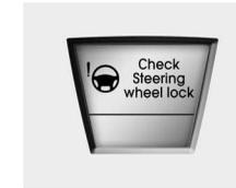
Se o volante não bloquear normalmente quando o botão ENGINE START/STOP roda para a posição OFF, a luz avisadora acende-se no visor LCD durante 10 segundos. Além disso, o sinal sonoro toca durante 3 segundos e a luz do botão ENGINE START/STOP pisca durante 10 segundos.
