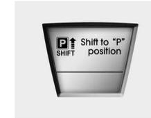
Se tentar desligar o motor sem o selector de mudanças na posição P (Park), o botão ENGINE START/STOP roda para a posição ACC. Se premir mais uma vez o botão, este regressa à posição ON. A luz avisadora acende-se no visor LCD durante aproximadamente 10 segundos para indicar que deve pressionar o botão ENGINE START/STOP com o selector de mudanças na posição P (Park). Além disso, o sinal sonoro faz-se ouvir durante cerca de 10 segundos (se instalado).
