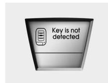
Se o dispositivo Smart Key não estiver dentro do veículo ou não for detectado e se o botão ENGINE START/STOP for pressionado, acende-se um aviso no visor LCD durante 10 segundos. Além disso, a luz indicadora do imobilizador de arranque e a luz do suporte da chave piscam durante 10 segundos.
