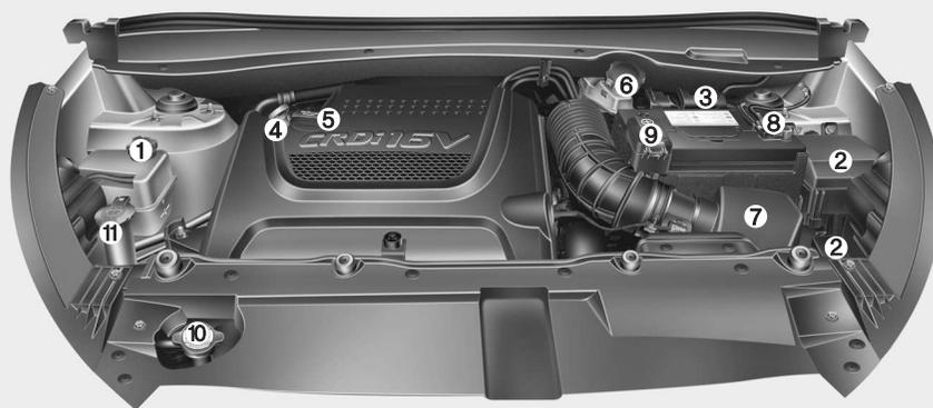
1. Depósito do líquido de refrigeração do motor
