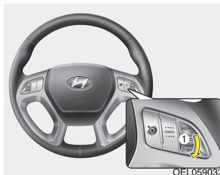
3. Desça o manípulo (1) (para "SET-") e liberte-o na velocidade pretendida. Acende-se a luz do indicador "SET" do combinado de instrumentos. Liberte o pedal do acelerador. A velocidade pretendida será mantida automaticamente.
