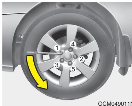
6. Desaperte as porcas da roda com uma volta de cada vez no sentido contrário ao dos ponteiros do relógio, mas não retire nenhuma porca até o pneu ser levantado do chão.
