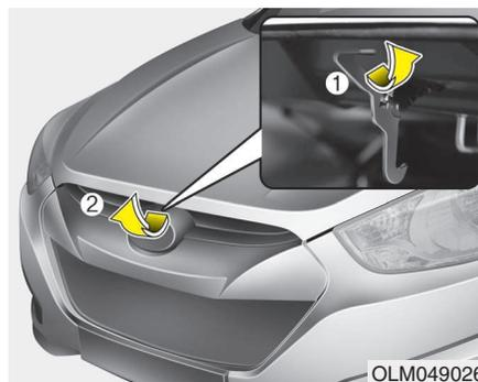
2. Vá à dianteira do veículo, levante ligeiramente o capô, puxe o fecho secundário (1) na parte central interior do capô e levante-o (2).
