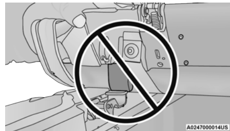
Retentor assentado incorretamente
