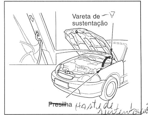
3. Levante o capô e mantenha-o aberto através da vareta de sustentação. A vareta está localizada no lado esquerdo do compartimento do motor e deve ser encaixada no orifício do capô.
