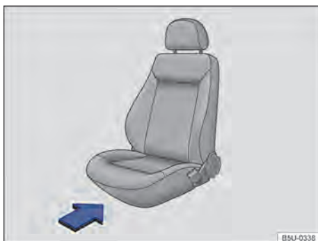
Fig. 50 Na parte frontal do banco do passageiro dianteiro: localização para instalação do suporte do extintor de incêndio.
