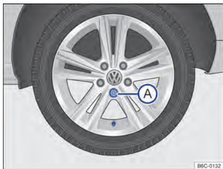
Fig. 169 Troca de roda: seqüência de remoção dos parafusos da roda.
