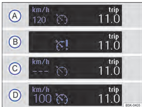
Fig. 100 No display do instrumento combinado: indicadores de status do GRA (representação esquemática).
