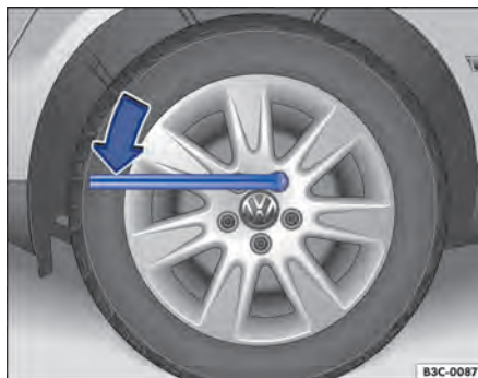
Fig. 166 Troca de roda: soltar os parafusos da roda.
