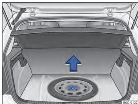
Fig. 124 No compartimento de bagagem, sob o revestimento de assoalho: roda de emergência e ferramentas de bordo.
