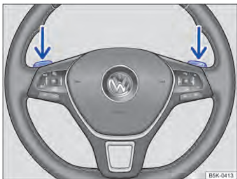
Fig. 97 Volante com seletores basculantes do Tiptronic.
