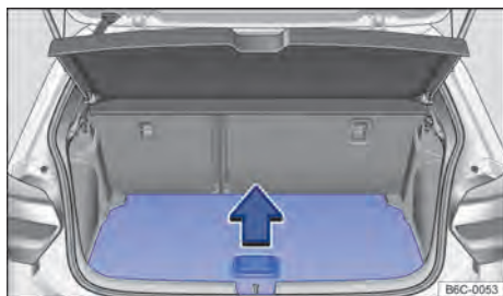
Fig. 117 No compartimento de bagagem: levantar o assoalho do compartimento de bagagem.
