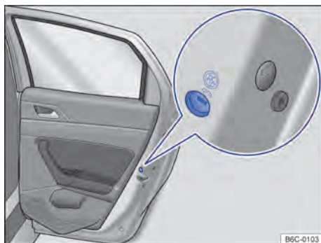
Fig. 47 Na porta traseira (lado direito): localização da trava de segurança para crianças.
