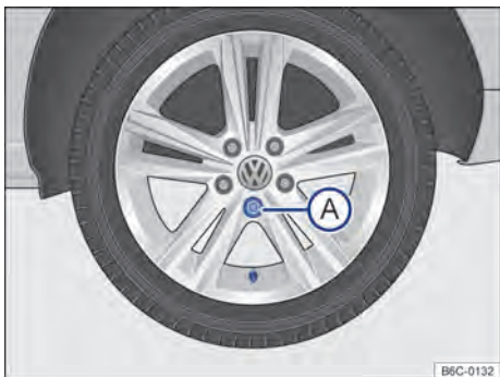
Fig. 164 Retirar a calota integral.
