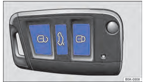
Fig. 53 Chave do veículo: travamento central.
