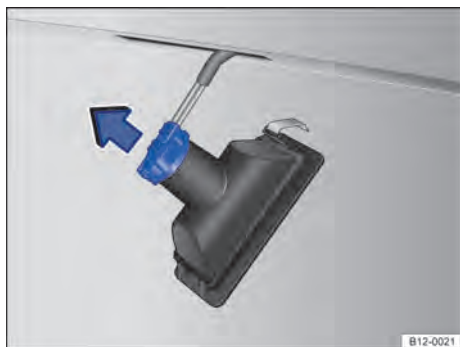
Fig. 115 Lanterna da placa de licença: remover o soquete da lâmpada.
