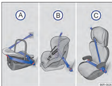
Fig. 35 As ilustrações A, B e C mostram a fixação do sistema de retenção para crianças apenas com o cinto de segurança do veículo.
