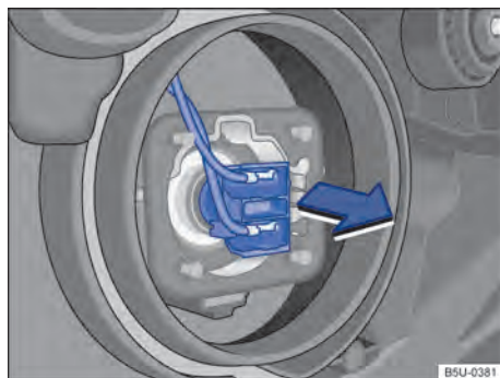
Fig. 110 Acesso à lâmpada incandescente do farol baixo.
