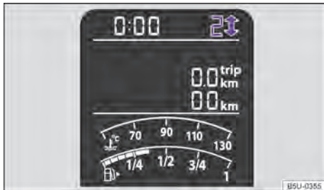
Fig. 87 No instrumento combinado: indicador de troca de marcha (variante 1).
