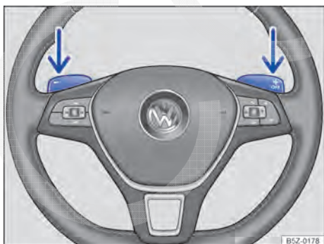
Fig. 96 Volante com dois seletores para troca de marcha no modo manual.
