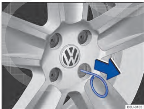
Fig. 164 Retirar as capas de cobertura dos parafusos da roda.
