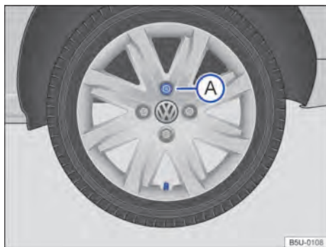
Fig. 142 Troca de roda: seqüência de remoção dos parafusos da roda.
