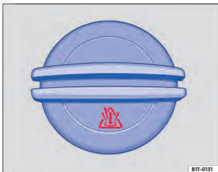
Fig. 128 No compartimento do motor: tampa do reservatório de expansão do líquido de arrefecimento do motor.
