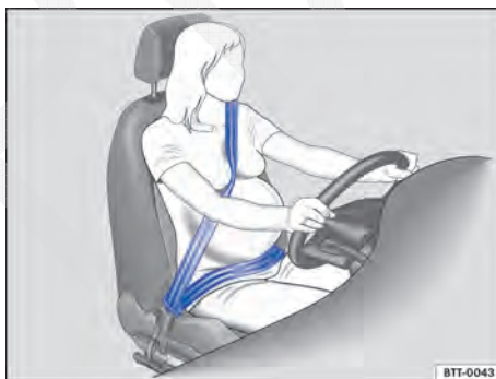
Fig. 50 Posição correta do cadarço do cinto de segurança para mulheres grávidas.
