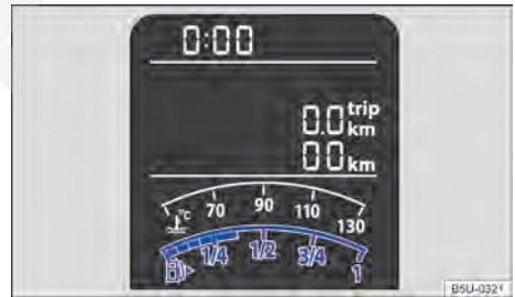
Fig. 118 No display do instrumento combinado: indicador do nível de combustível (variante 1).
