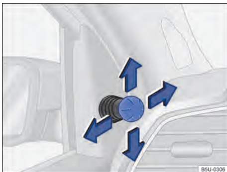
Fig. 70 Nas portas dianteiras: interruptor de ajuste dos espelhos retrovisores externos mecânicos.
