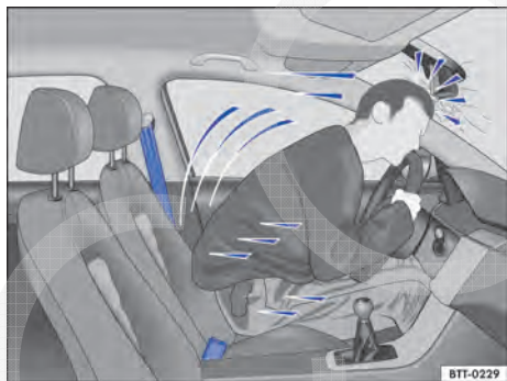
Fig. 44 O condutor sem cinto de segurança é lançado para frente.
