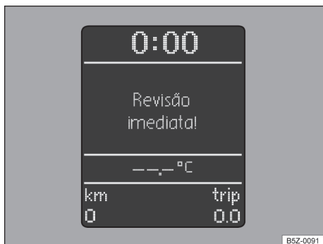
Fig. 11 Display do instrumento combinado: indicação do intervalo de serviço.
