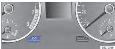
Fig. 60 No instrumento combinado: tecla de regulagem da iluminação dos instrumentos e dos interruptores.
