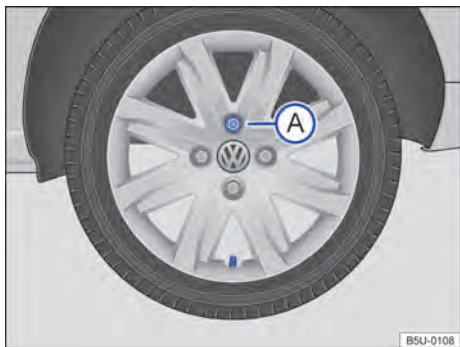
Fig. 138 Retirar a supercalota.
