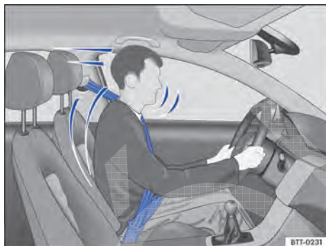
Fig. 46 Condutor protegido pelo cinto de segurança colocado corretamente em uma manobra de frenagem súbita.
