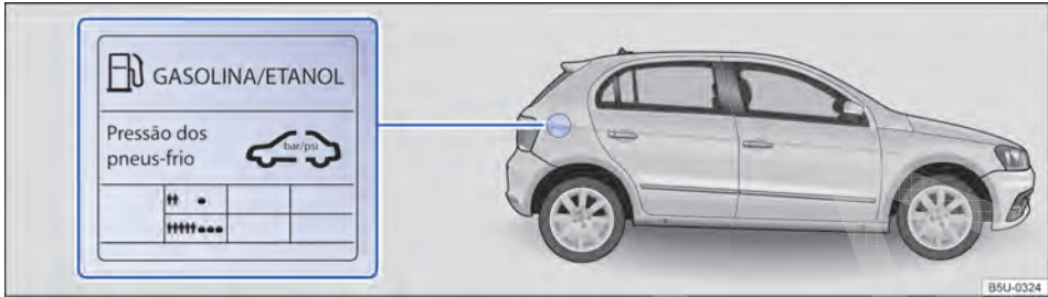
Fig. 133 Na parte interna da portinhola do tanque de combustível: etiqueta com a pressão dos pneus.
