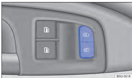
Fig. 25 Na porta do condutor: teclas do travamento central.
