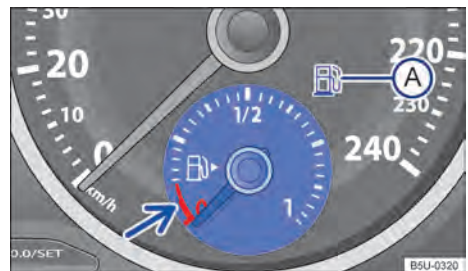
Fig. 119 No instrumento combinado: indicador do nível de combustível (variante 2).
