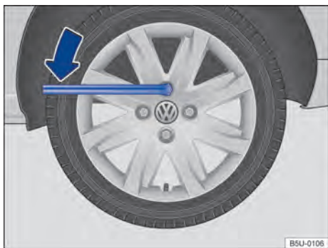
Fig. 139 Troca de roda: soltar os parafusos da roda.
