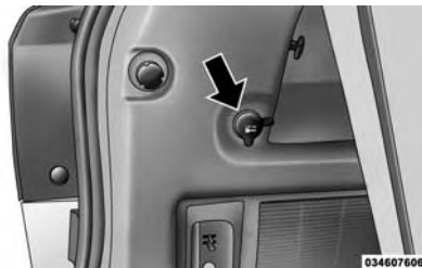
Tomada de Alimentação da Área de Carga Traseira
