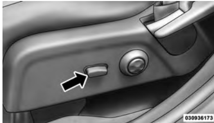
Interruptor do Banco com Ajuste Elétrico
