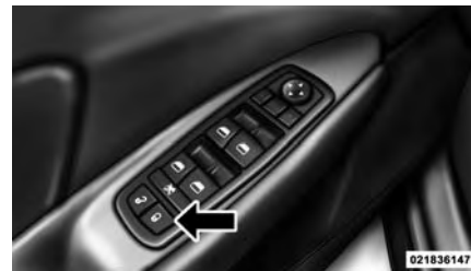
Localização do Interruptor de Travamento Elétrico de Portas
