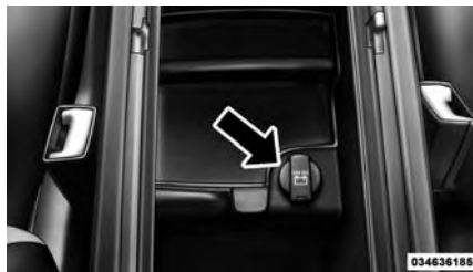
Tomada de Alimentação de 12 V do Console Central
